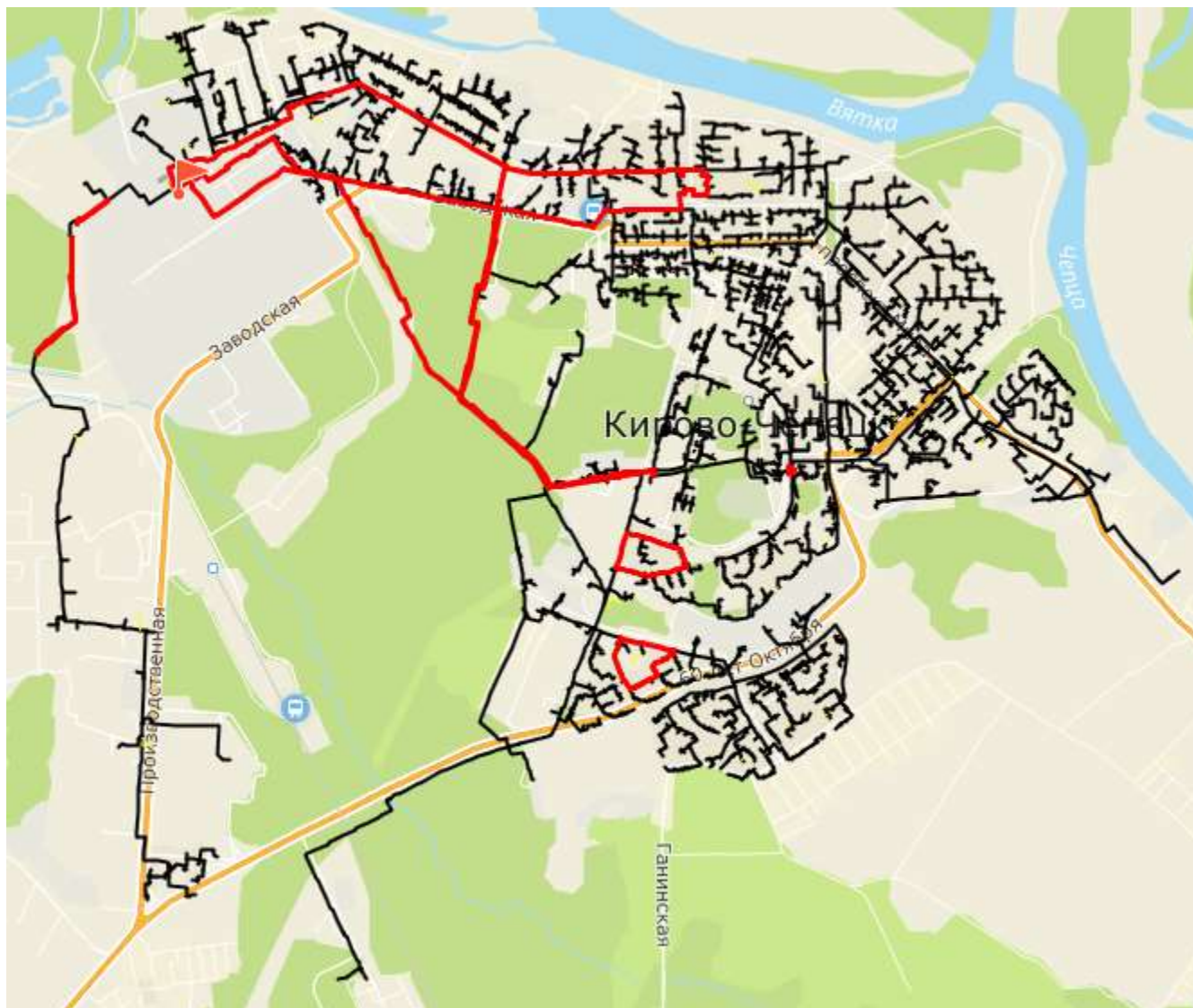
Рисунок 37 – Закольцовки тепловых сетей в зоне действия ТЭЦ-3
