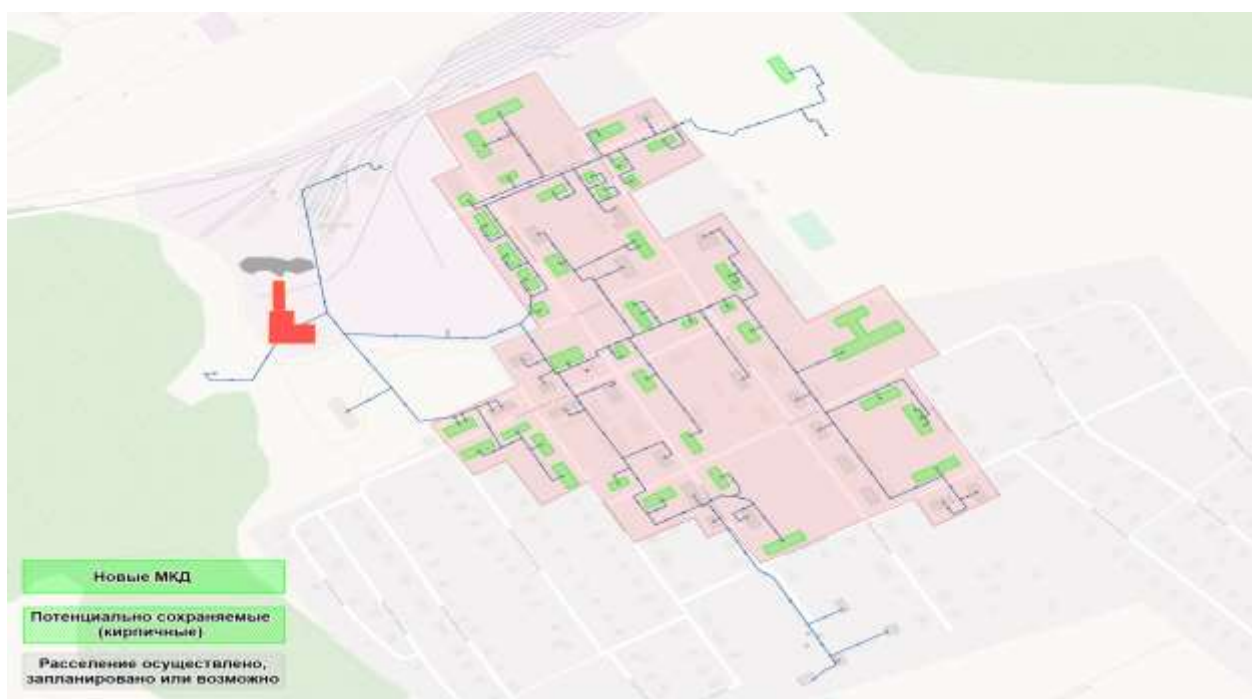
Рисунок 8 – Зона теплоснабжения котельной Каринторф после ожидаемого расселения
