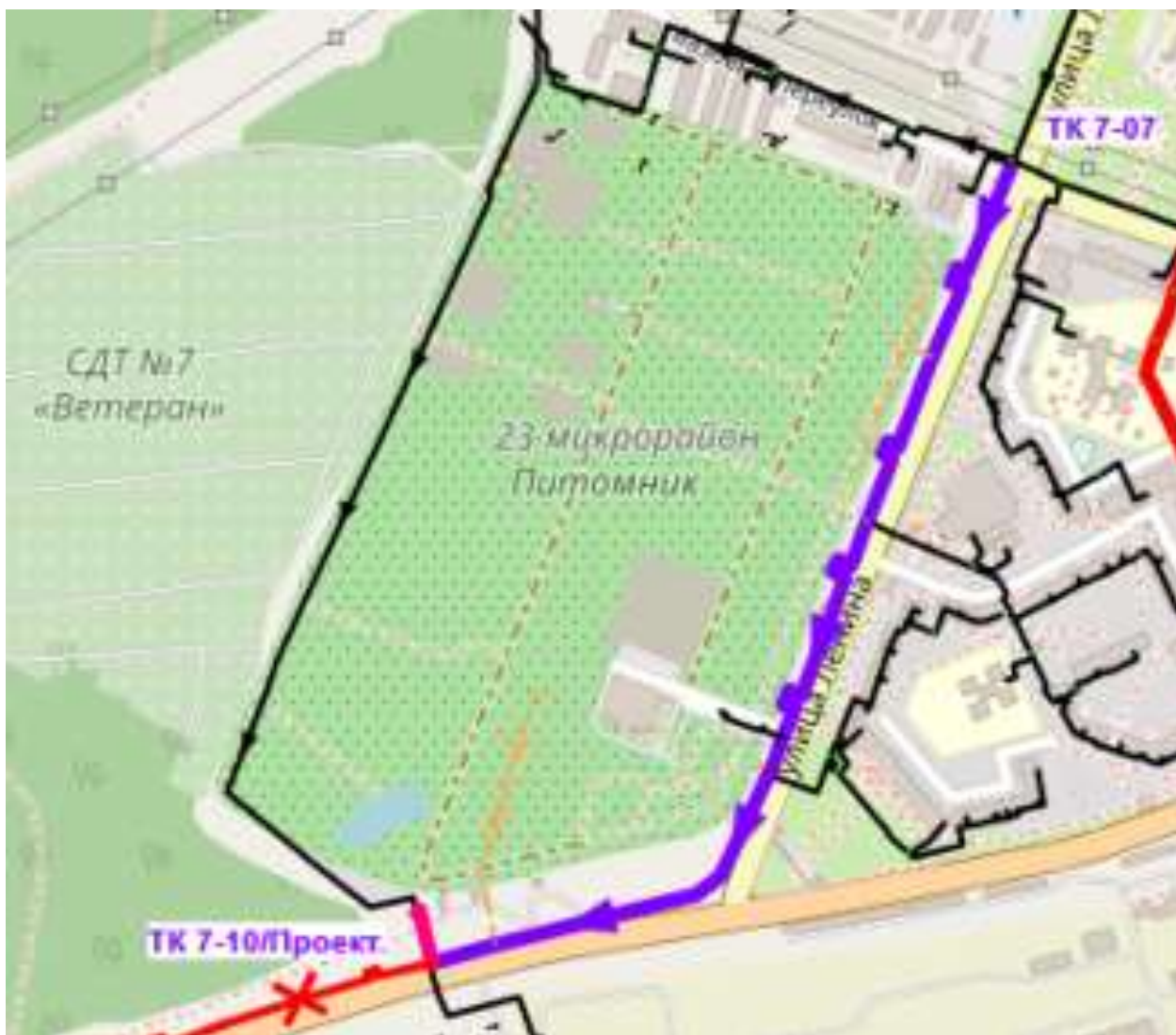
Рисунок 3 – Реконструкция с уменьшением диаметра трубопроводов участков тепловых сетей Ду600-500 мм на Ду250-200 мм от ТК 7-07 до пересечения с магистралью ООО «СХП Тепличный комбинат»
