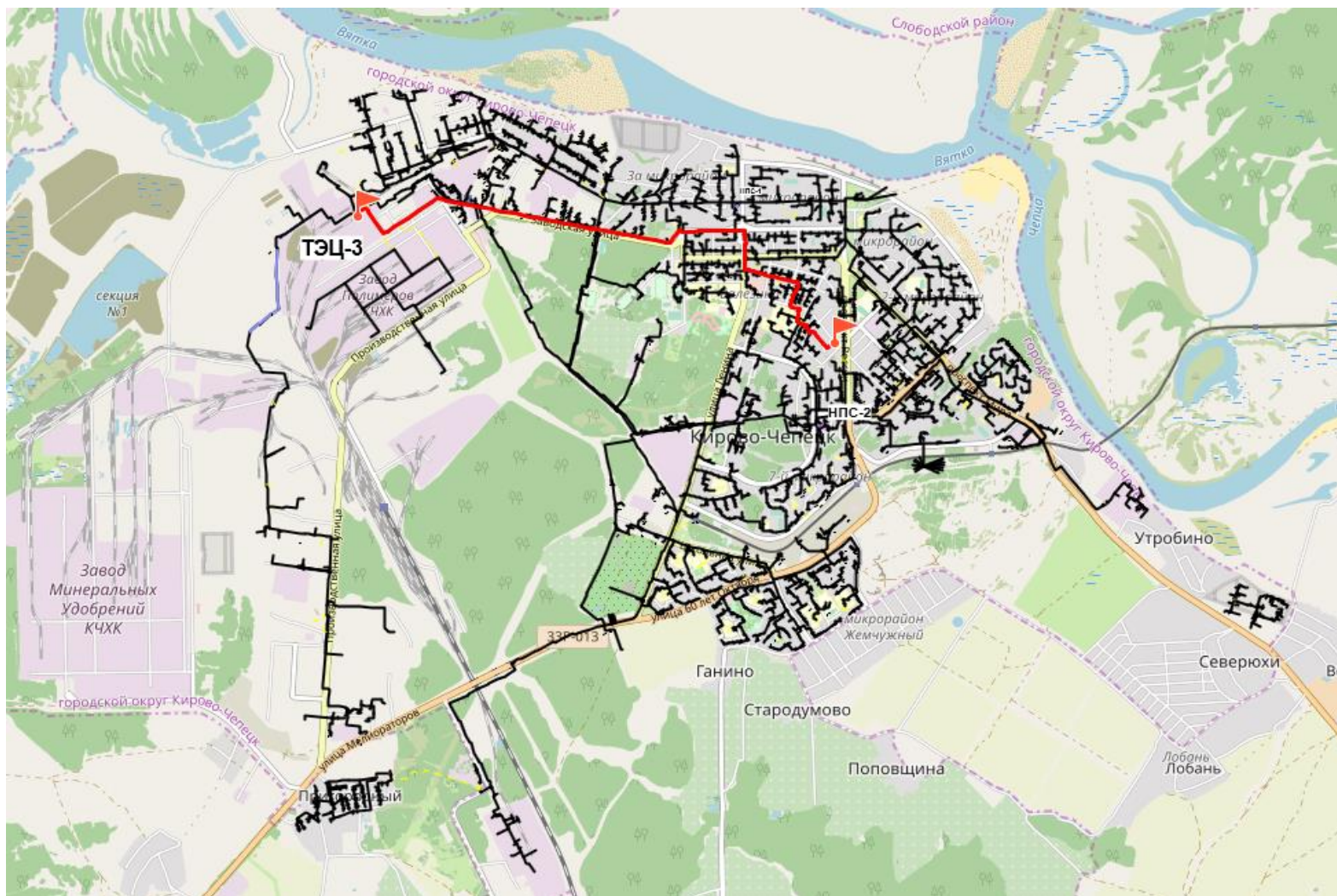
Рисунок 11 – Путь движения теплоносителя от источника тепловой энергии до конечного потребителя, в зоне действия ТЭЦ №3 (центральная часть) (рисунок П46.1 МУ)
