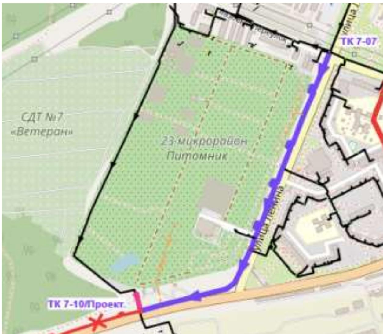
**Рисунок 5 – Реконструкция с уменьшением диаметра трубопроводов участков тепловых сетей Ду600-500 мм на Ду250-200 мм от ТК 7-07 до пересечения с магистралью ООО «СХП Тепличный комбинат»**
