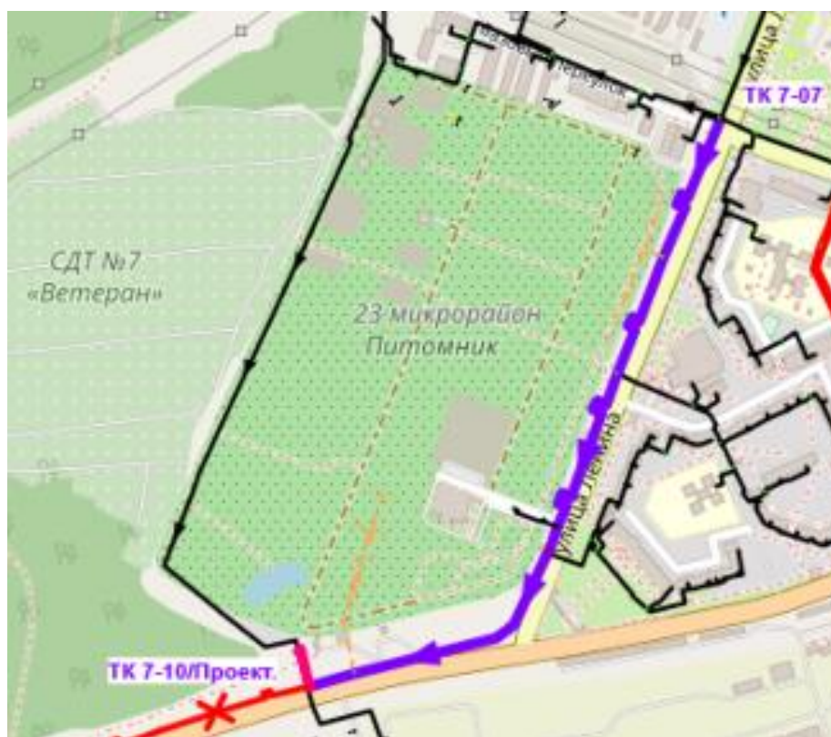
Рисунок 20 – Реконструкция с уменьшением диаметра трубопроводов участков тепловых сетей Ду600-500 мм на Ду250-200 мм от ТК 7-07 до пересечения с магистралью ООО «СХП Тепличный комбинат»
