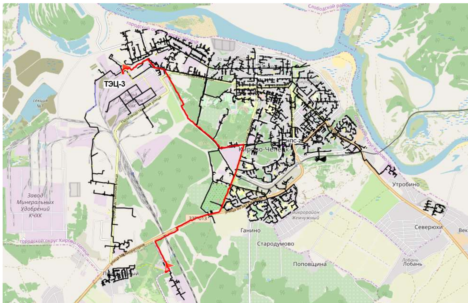
Рисунок 7 – Путь движения теплоносителя от источника тепловой энергии до конечного потребителя, в зоне действия котельной ТЭЦ №3 (Пригородный) (рисунок П46.1 МУ)
