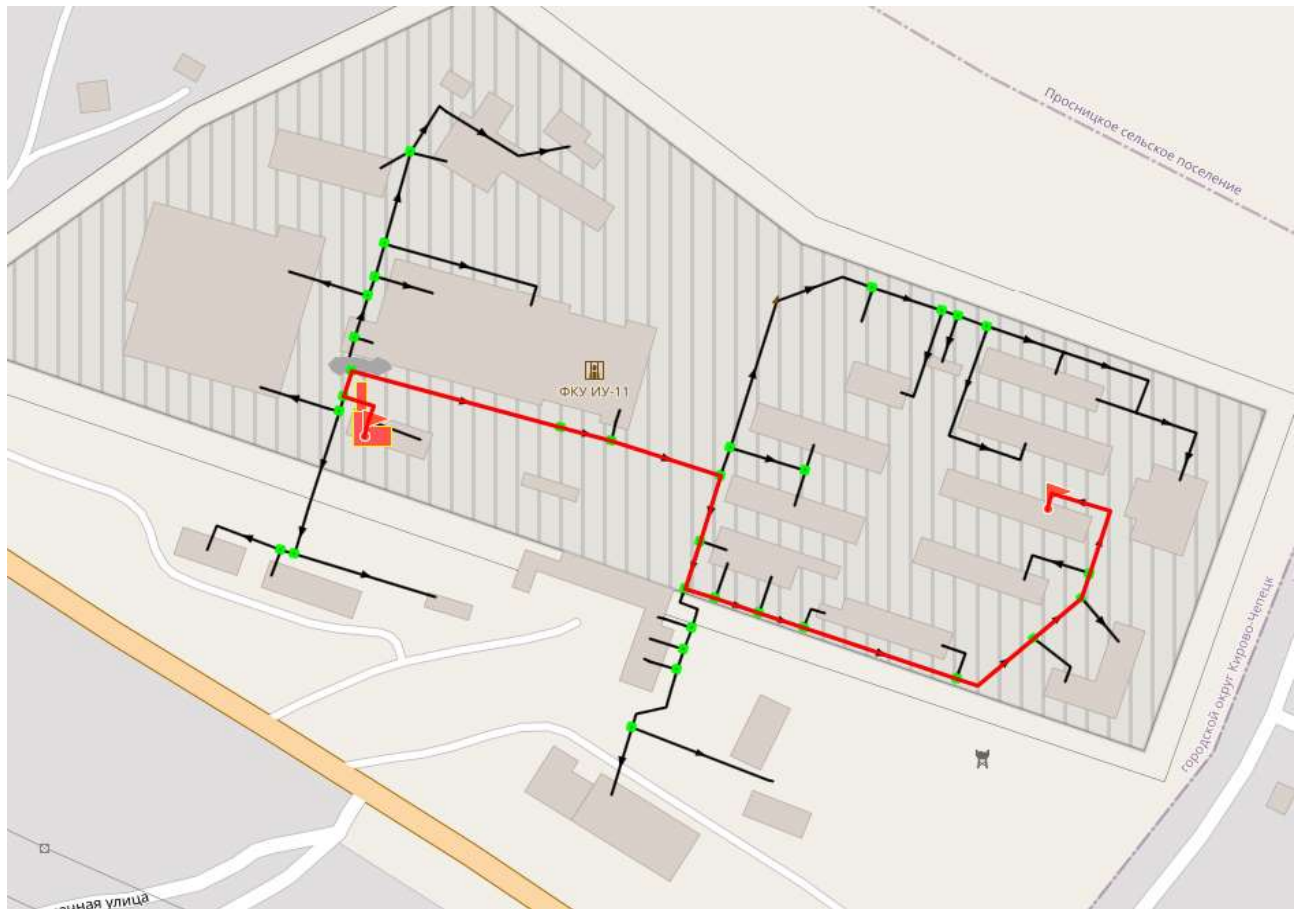
Рисунок 17 – Путь движения теплоносителя от источника тепловой энергии до конечного потребителя, в зоне действия котельной ИК-11 (рисунок П46.1 МУ)
