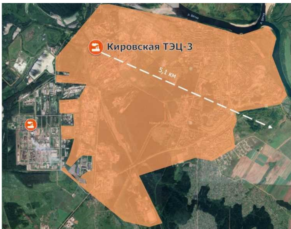
Рисунок 9 – Радиус эффективного теплоснабжения Кировской ТЭЦ-3
