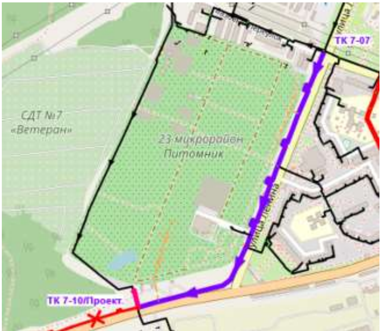
Рисунок 7 – Реконструкция с уменьшением диаметра трубопроводов участков тепловых сетей Ду600-500 мм на Ду250-200 мм от ТК 7-07 до пересечения с магистралью ООО «СХП Тепличный комбинат»
