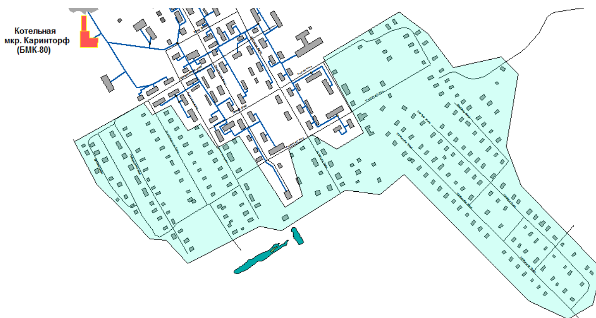
Рис. 1.2. Зона действия индивидуального теплоснабжения (выделено зеленым цветом) в городе Кирово-Чепецке в микрорайоне Каринторф
