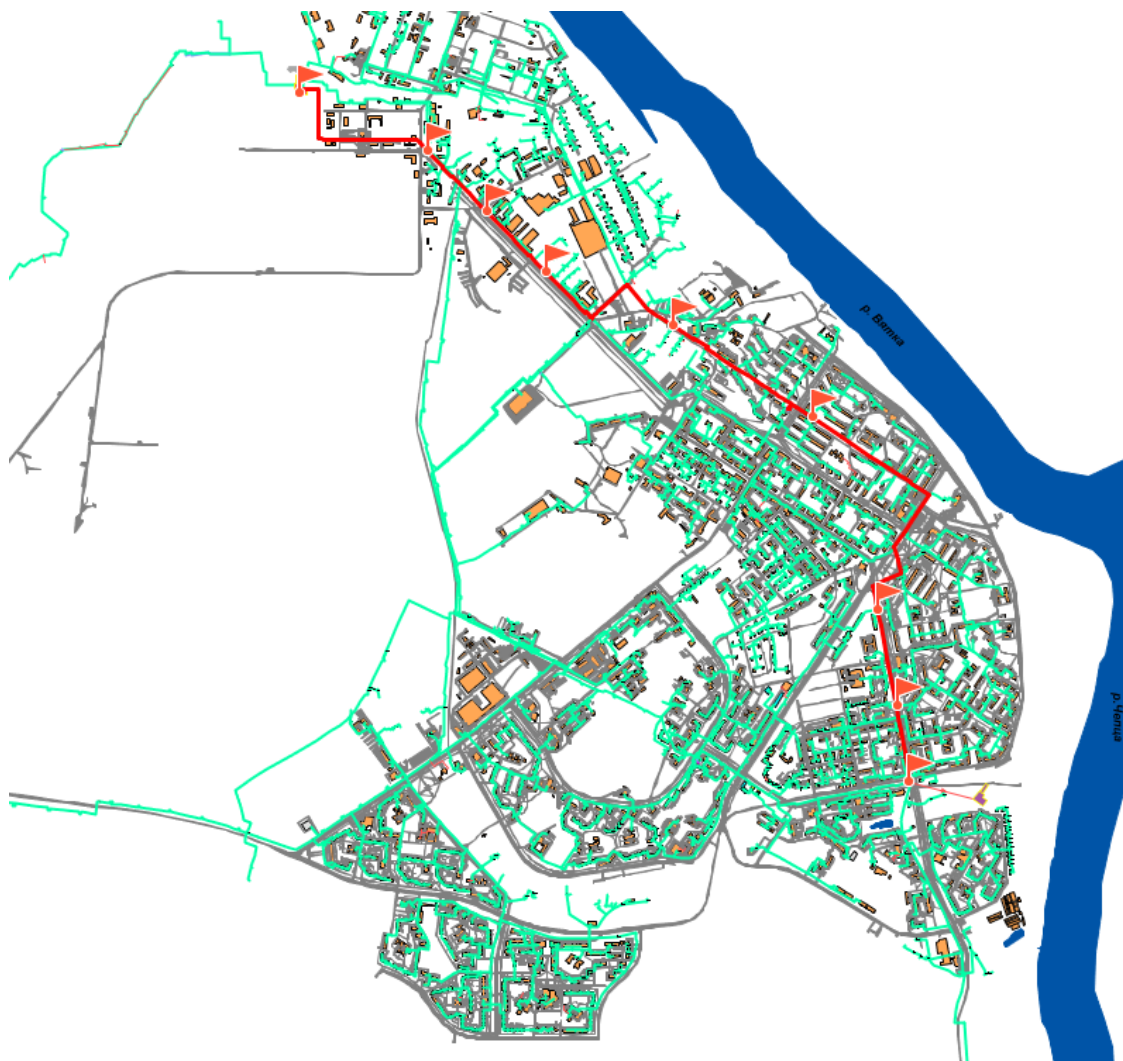
Рис. 9.1.12. Резервный участок теплосети Кировской ТЭЦ-3 до ТК 5-12
