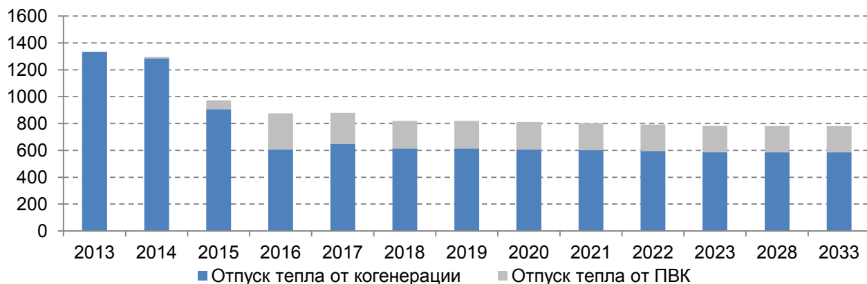
Рис. 1.3.8. Отпуск тепловой энергии внешним потребителям по старой части Кировской ТЭЦ-3 на 2013 - 2033 годы (включая отпуск с паром) , тыс. Гкал
