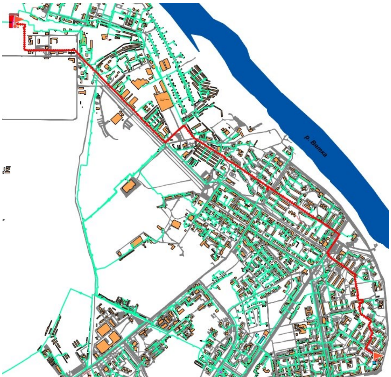
Рис. 2.3.5. Расчетная схема участка тепловой сети от ТЭЦ-3 до ТК 4-32 (через Черемушки)
