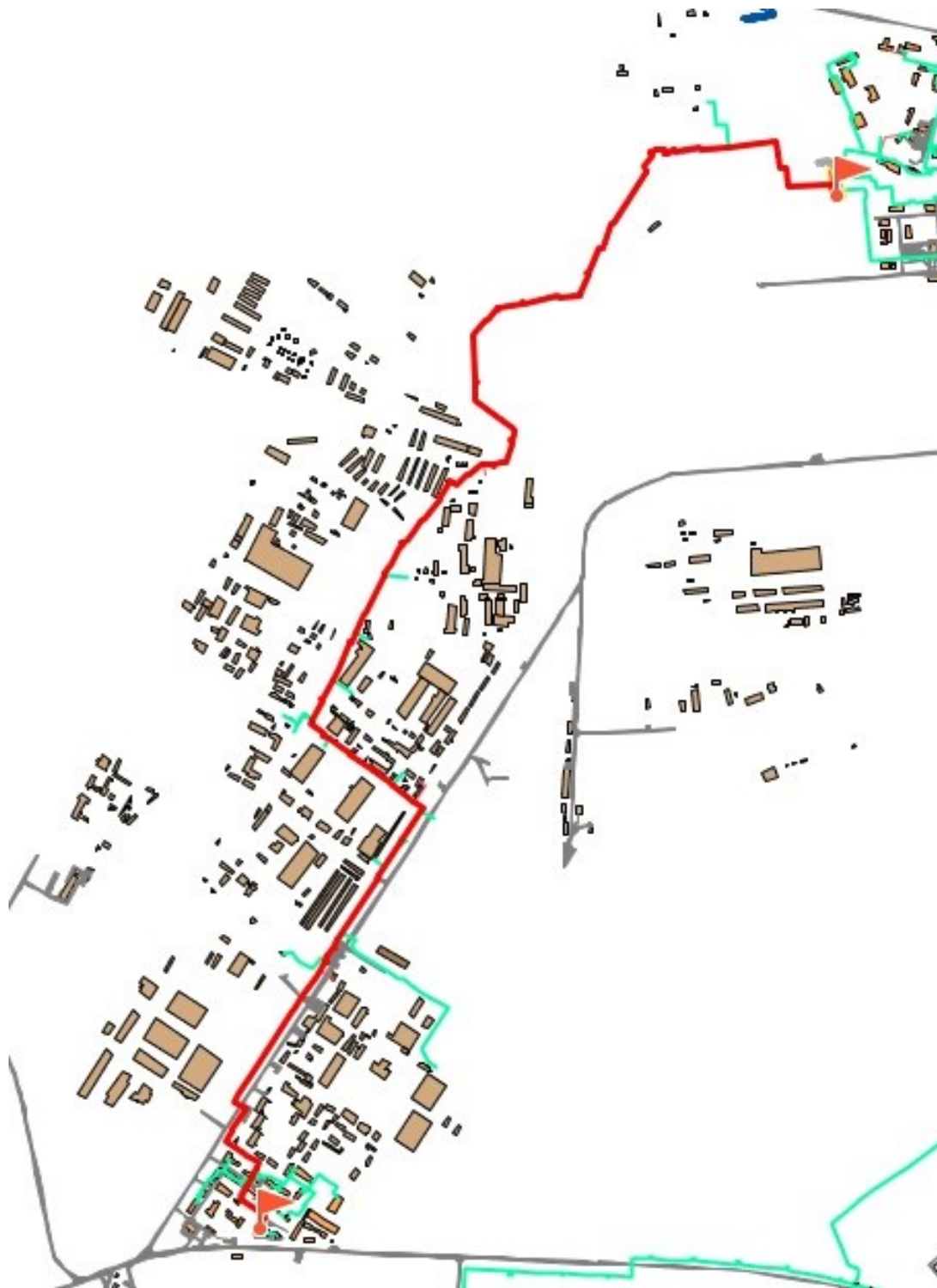
Рис. 2.2.1. Расчетная схема участка тепловой сети от ТЭЦ-3 до Уз. ПМК-6
