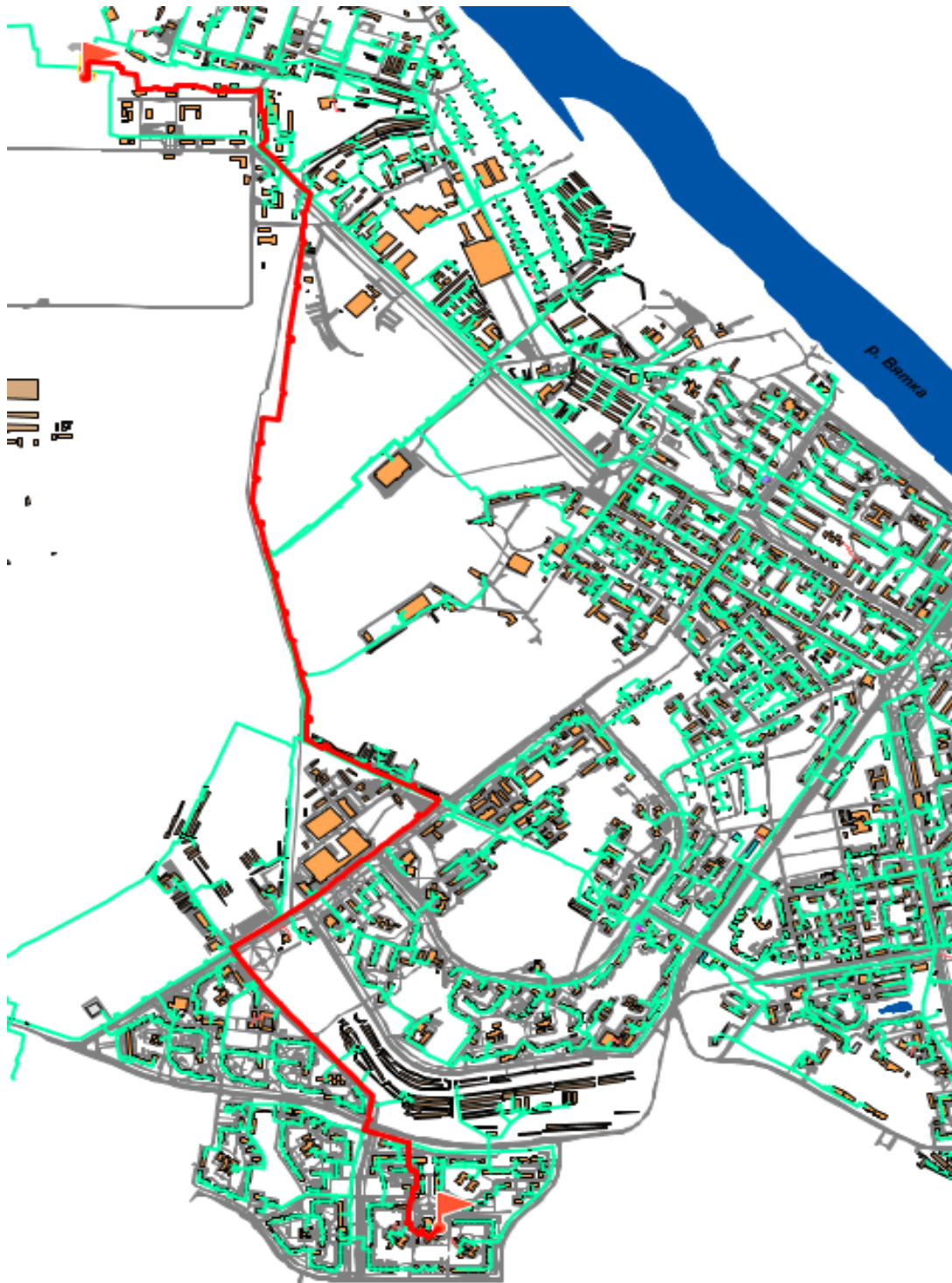
Рис. 2.3.11. Расчетная схема участка тепловой сети от ТЭЦ-3 до ТК 10-10-17
