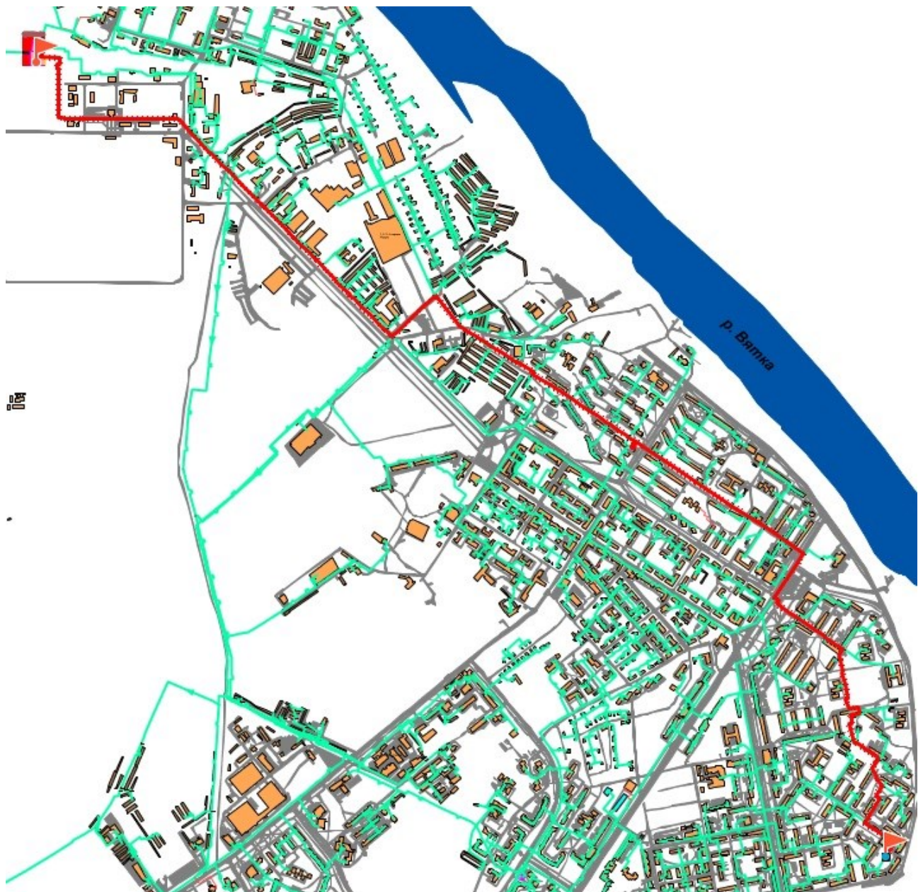
Рис. 2.1.5. Расчетная схема участка тепловой сети от ТЭЦ-3 до ТК 2-24 (через Черемушки)
