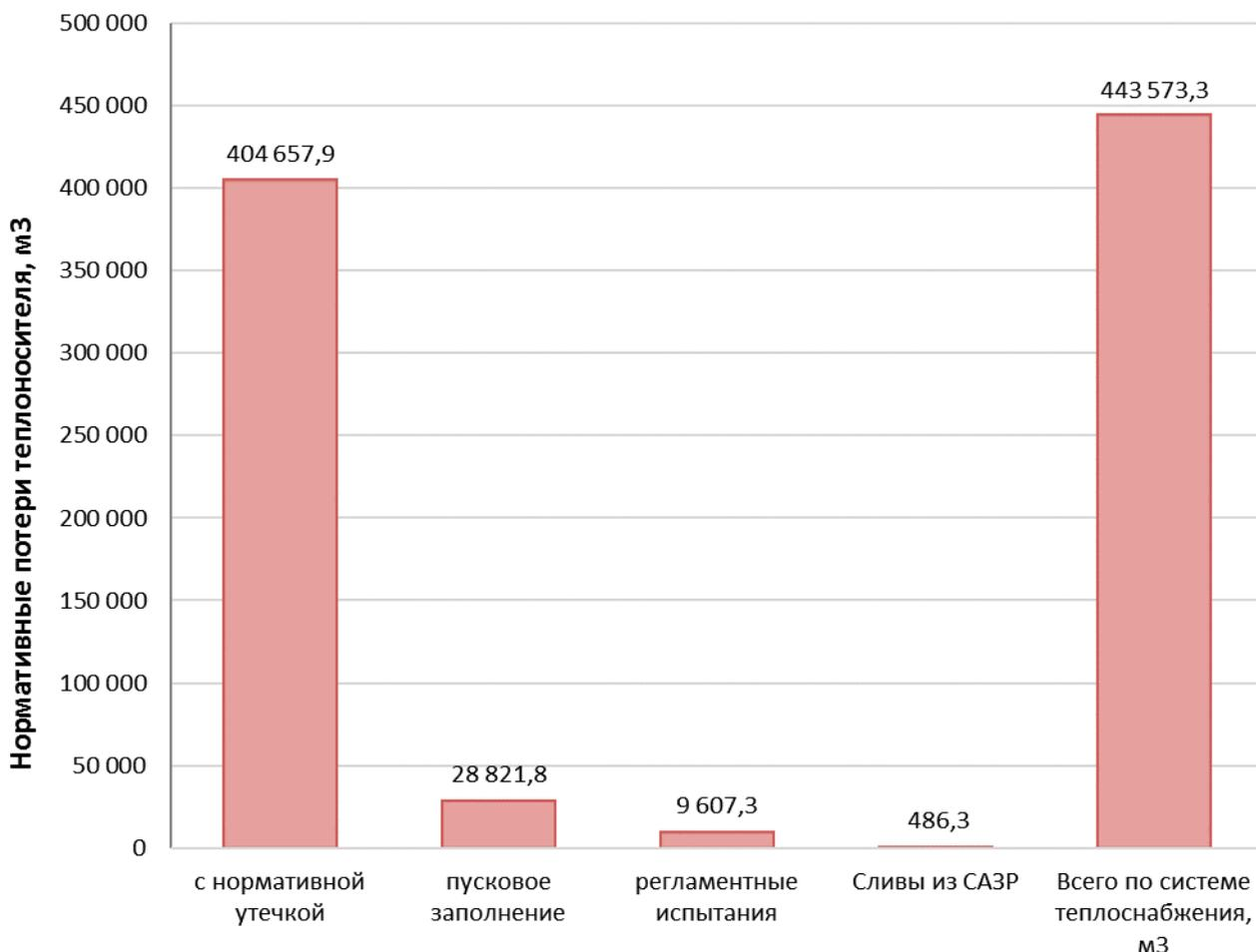
**Рис. 2.1.1. Расчетные значения потерь теплоносителя с нормативной утечкой, на пусковое заполнение, на регламентные испытания для магистральных, квартальных тепловых сетей, потребителей и суммарно по системе теплоснабжения**
