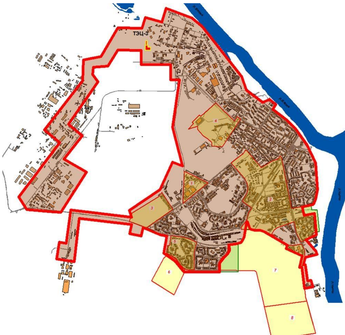
Рис. 2.1.3. Существующая (обведена жирной красной чертой) и перспективная (выделена зелёным) зоны действия ТЭЦ-3 с указанием перспективных площадок строительства (выделены жёлтым, обведены красной тонкой чертой)
