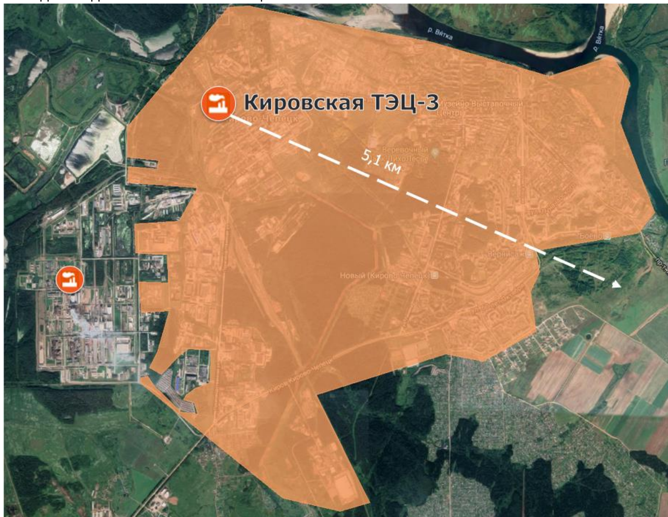
Рис. 2.1.2. Зона действия Кировской ТЭЦ-3 (стрелкой обозначен радиус эффективного теплоснабжения)
