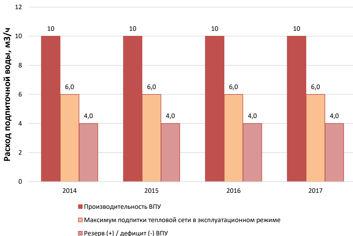
Рис. 3.6.1. Балансы производительности водоподготовительной установки, общей подпитки тепловой сети, резерва/дефицита котельной МКР Каринторф в период 2014-2017 гг.
