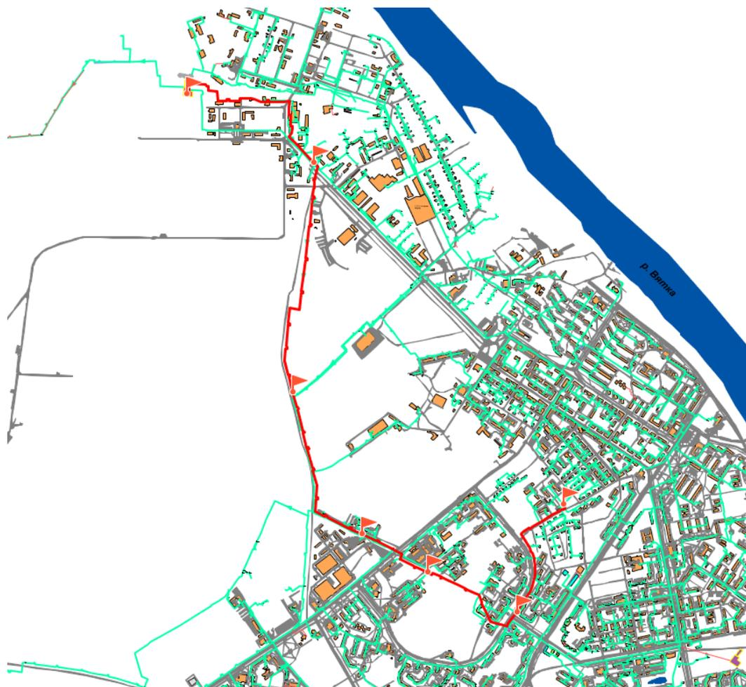
Рис. 9.1.6. Расчетный участок тепловой сети Кировская ТЭЦ-3 – Уз 3-47
