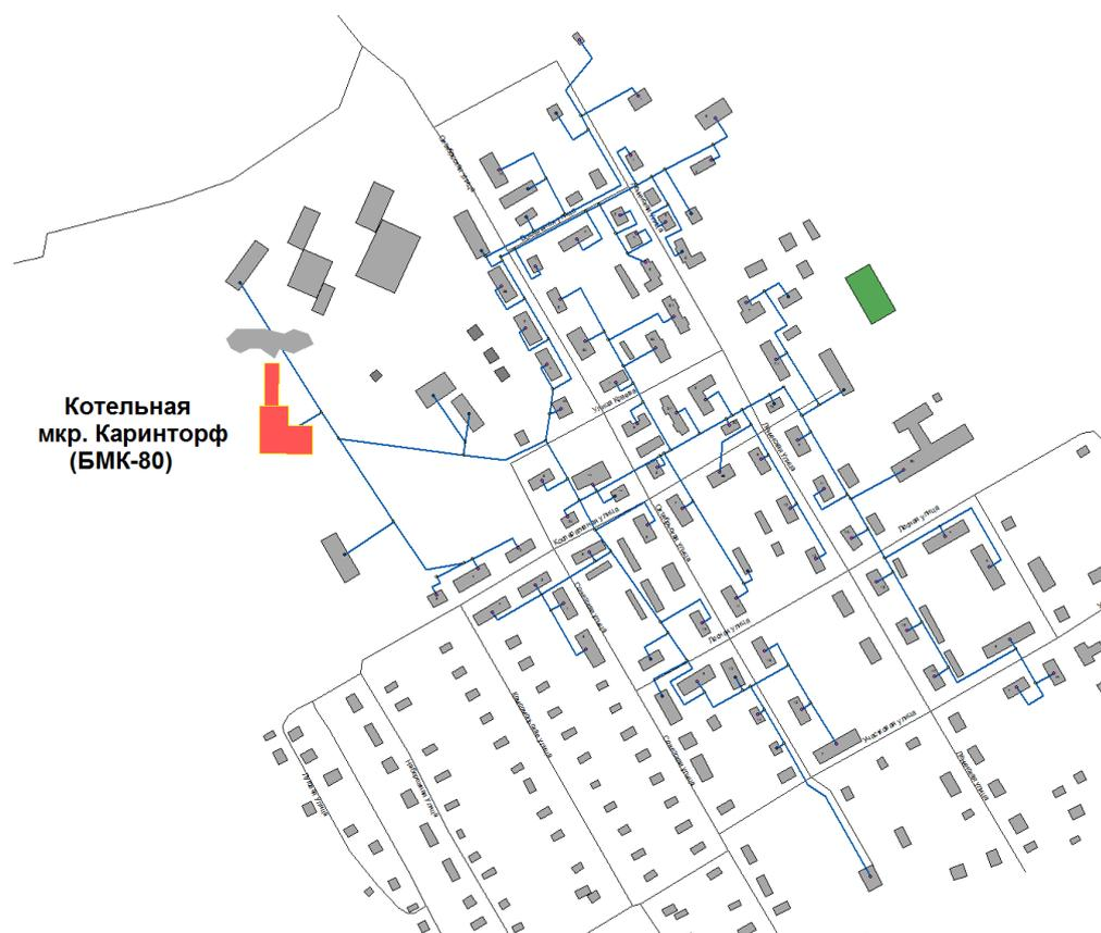
Рис. 3.2.1. Общий вид тепловых сетей в зоне теплоснабжения котельной МКР Каринторф
