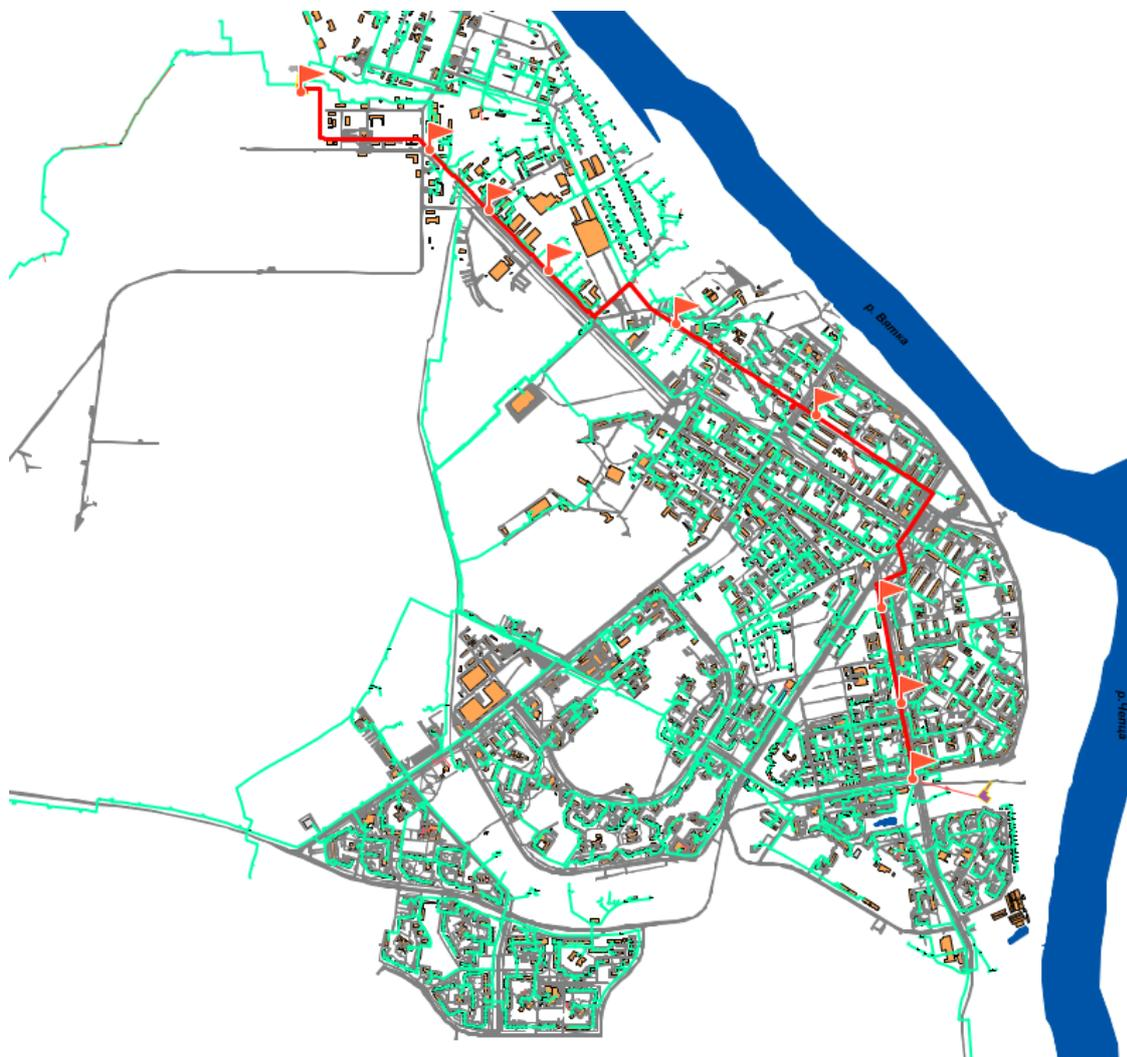
Рис. 9.1.12. Резервный участок теплосети Кировской ТЭЦ-3 до ТК 5-12
