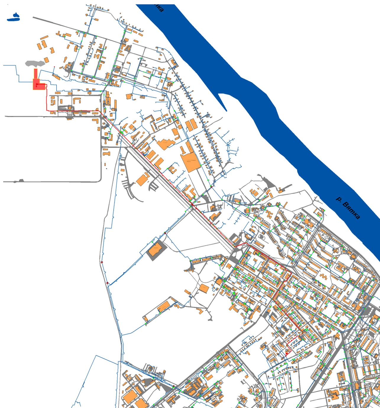
Рис. 9.1.5. Расчетный участок тепловой сети Кировская ТЭЦ-3 – Уз 3-47
