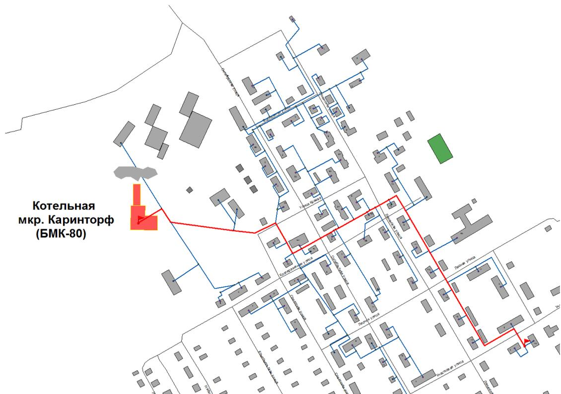
Рис. 6.2.1. Расчетный участок тепловой сети от котельной мкр. Каринторф
