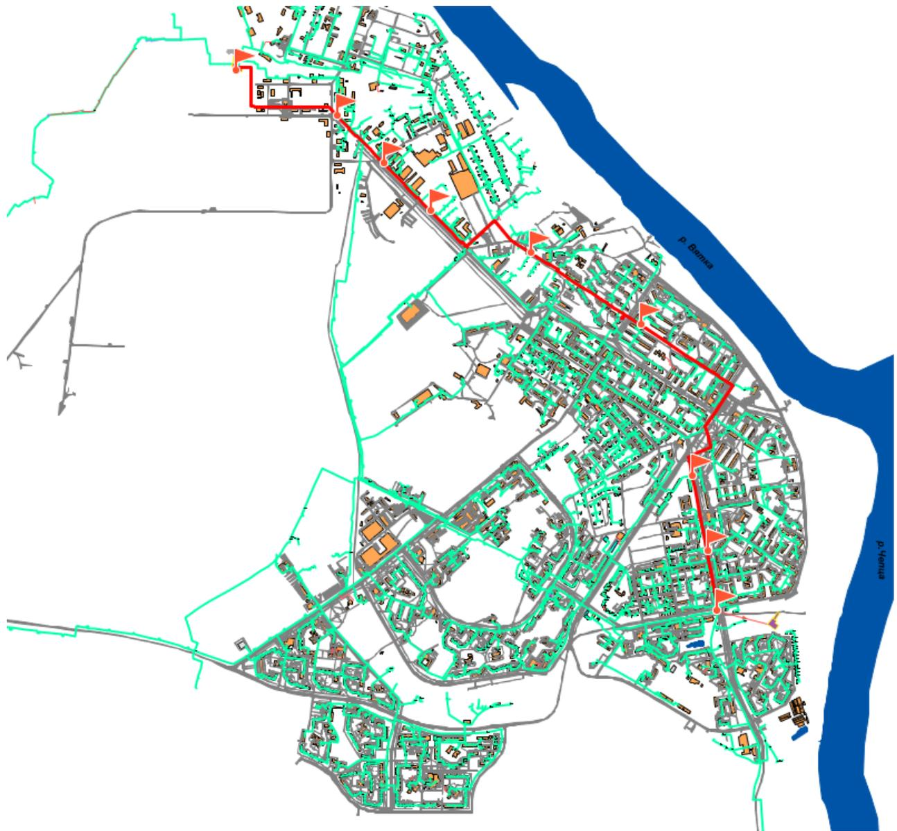
Рис. 2.1.12. Резервный участок теплосети Кировской ТЭЦ-3 до ТК 5-12
