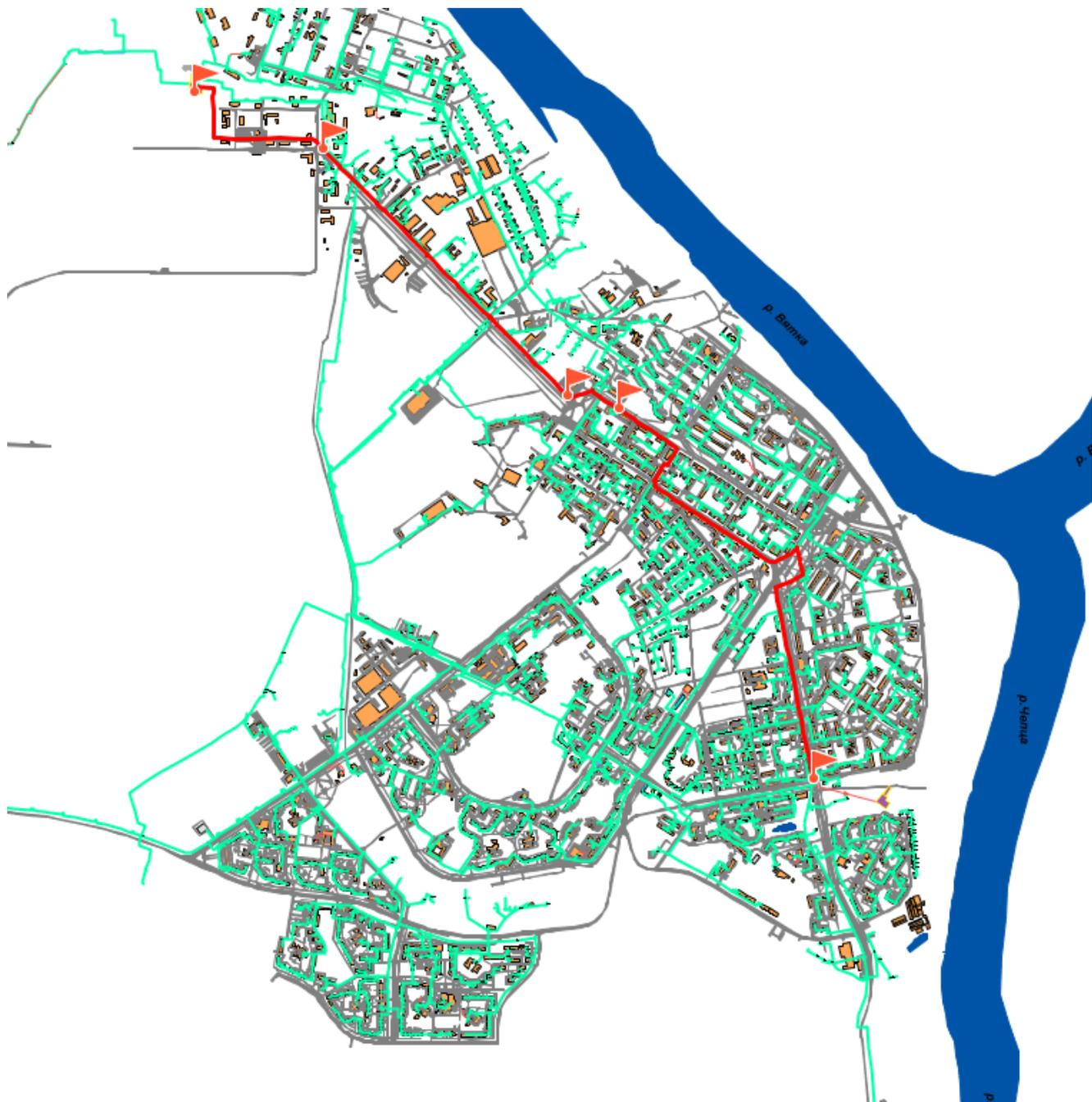
Рис. 2.1.16. Расчетный участок теплосети Кировской ТЭЦ-3 до ТК-4-32
