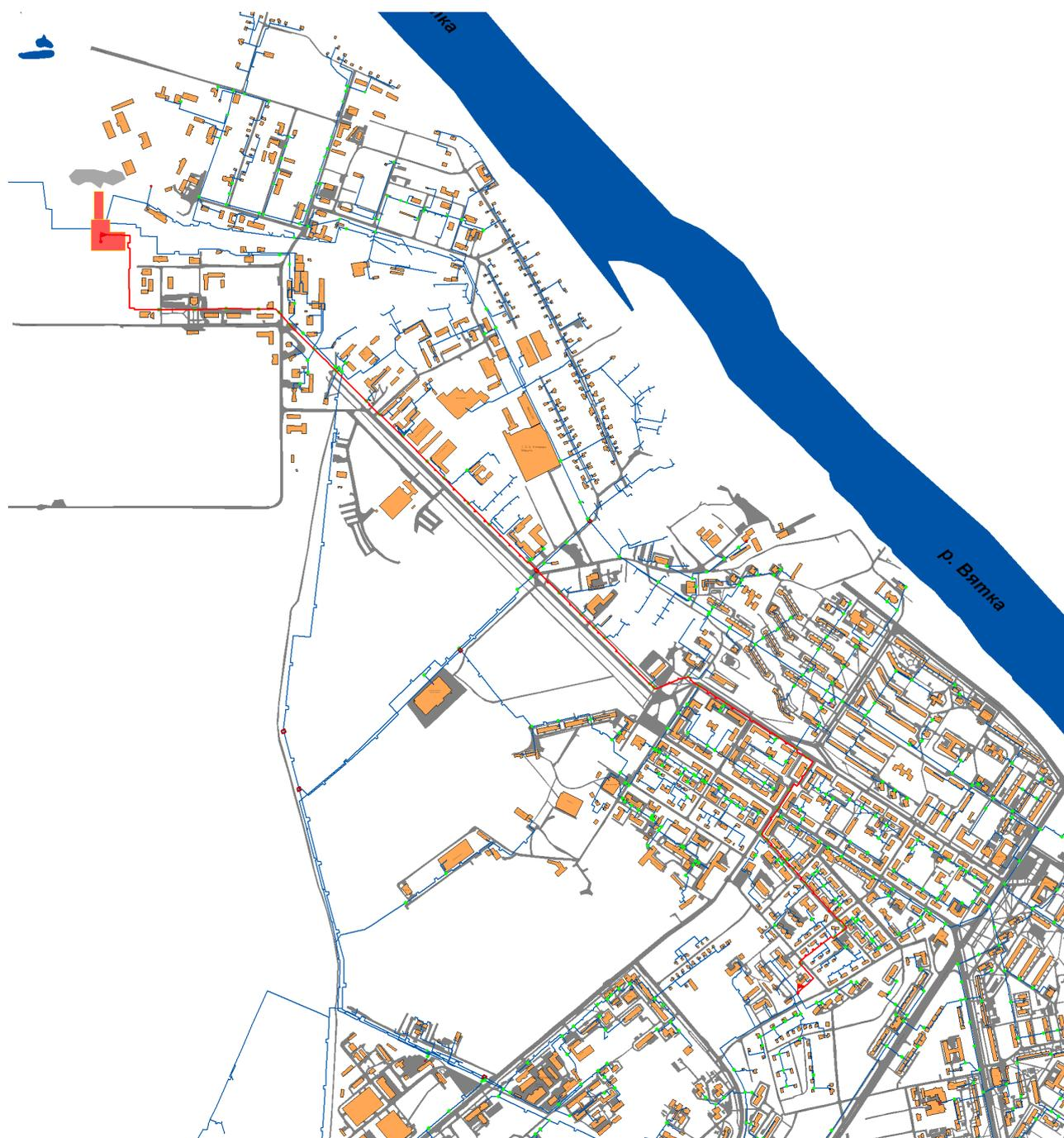
Рис. 2.1.5. Расчетный участок тепловой сети Кировская ТЭЦ-3 – Уз 3-47
