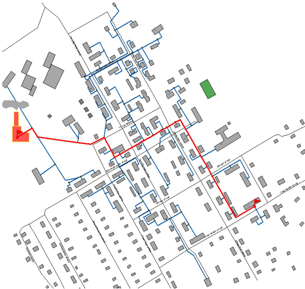
Рис. 2.2.1. Расчетный участок теплосети от котельной БМК – 8,0 до ул. Участковой д. 4,4а,5.
