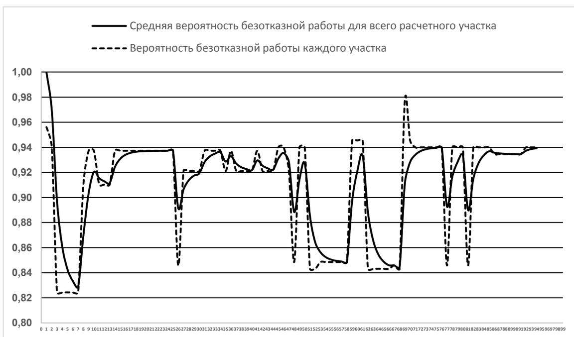
Рис. 2.1.14 Вероятность безаварийной работы тепломагистрали от ТЭЦ-3 до 5-12 резерв
