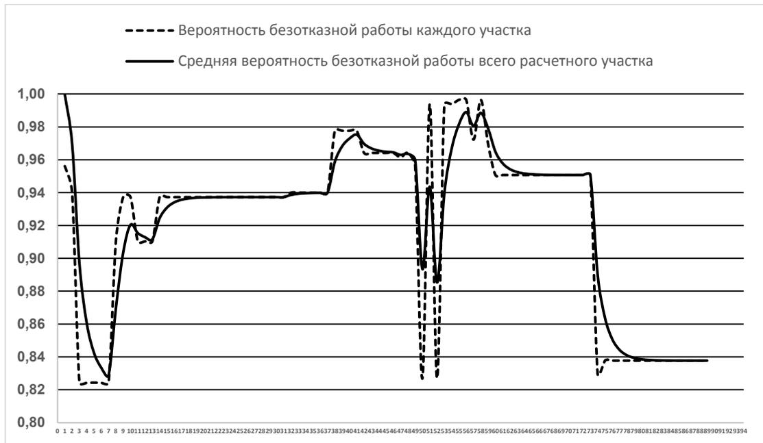
Рис. 2.1.7. Вероятность безаварийной работы тепловой магистрали от ТЭЦ-3 до Уз 3-47 основная
