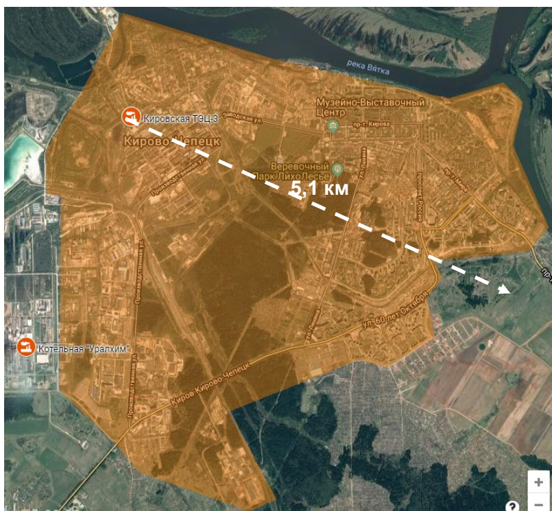
Рис. 2.4.2. Зона действия Кировской ТЭЦ-3 (стрелкой обозначен радиус эффективного теплоснабжения)
