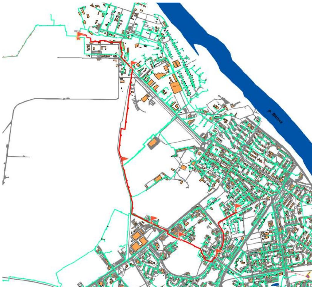
Рис. 9.1.6. Расчетный участок тепловой сети Кировская ТЭС-3 – Уз 3-47
