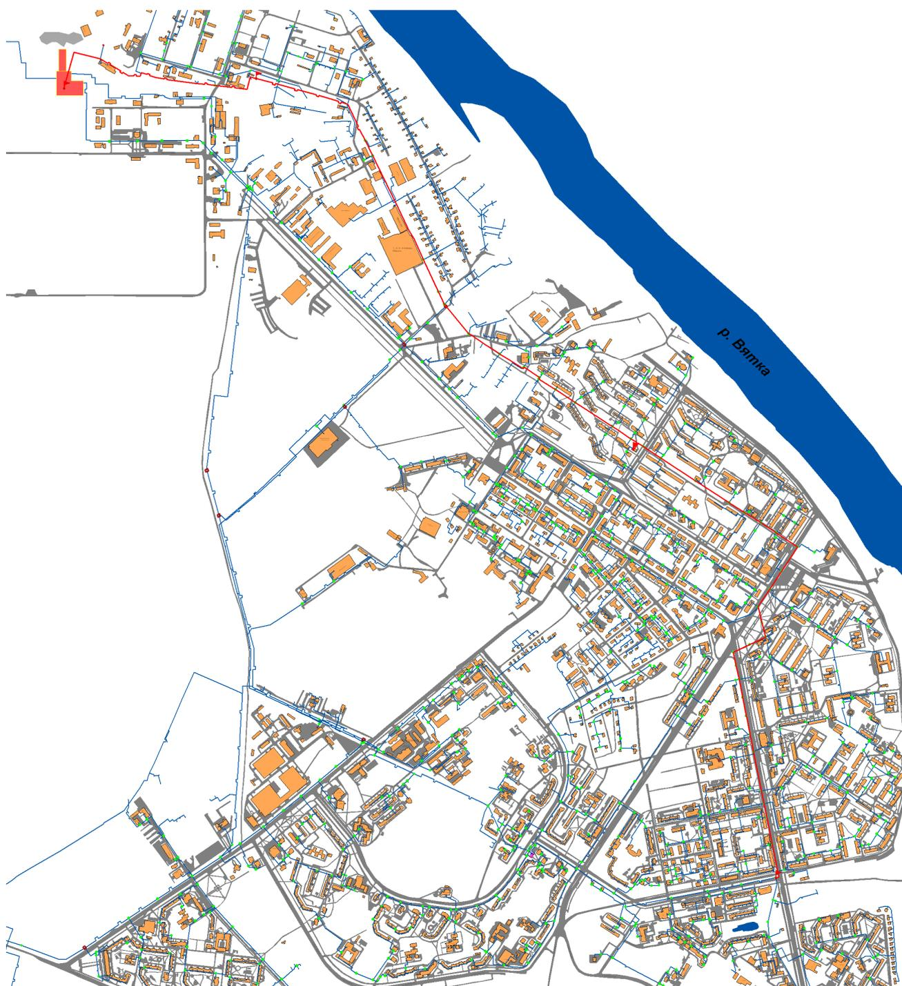
Рис. 9.1.11. Расчетный участок теплосети Кировской ТЭЦ-3 до ТК 5-12
