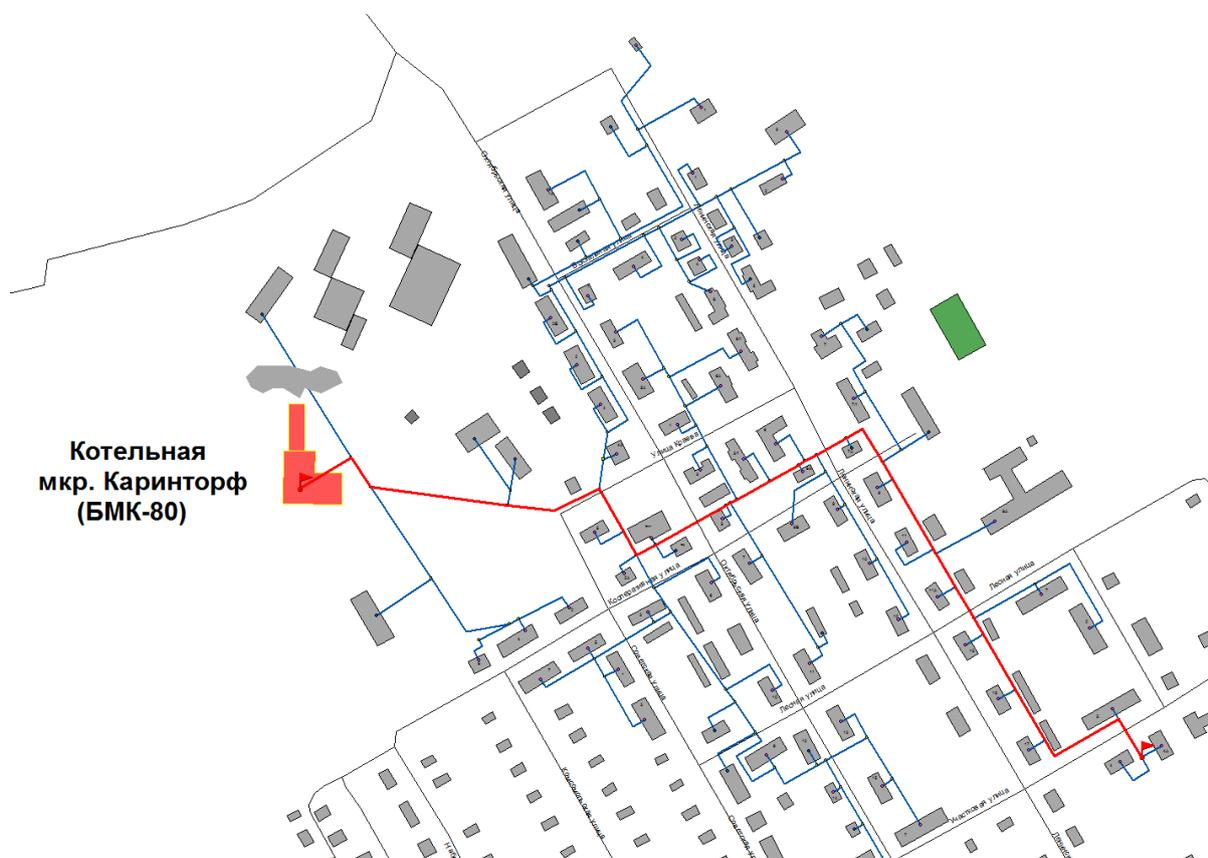
Рис. 3.2.4. Расчетный участок тепловой сети от котельной мкр. Каринторф
