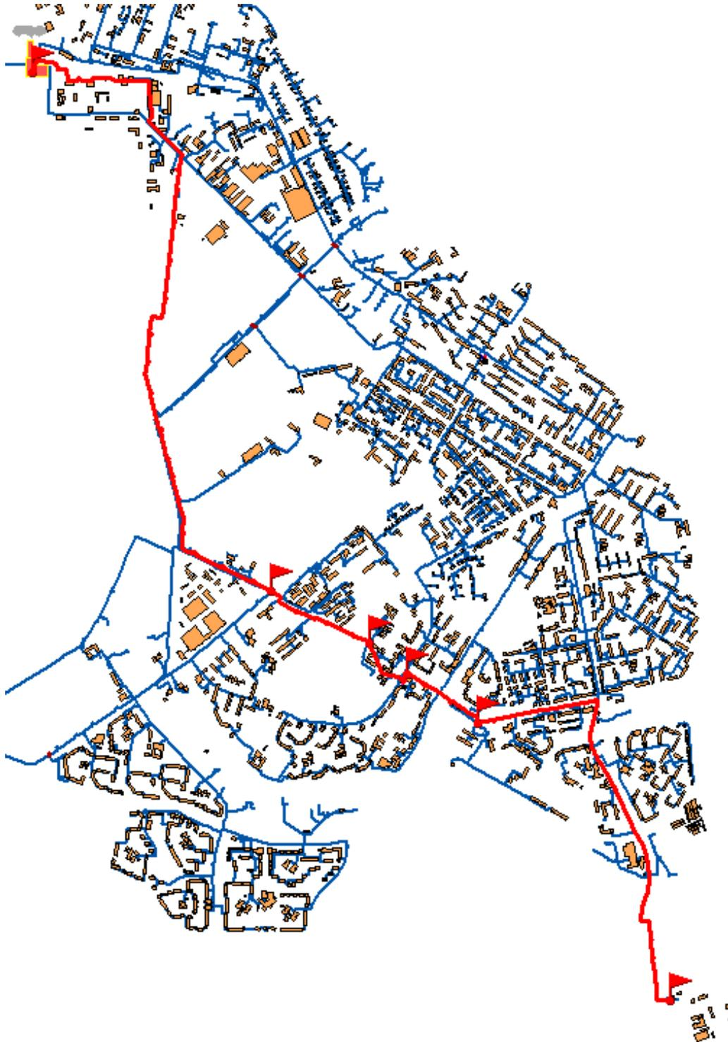
Рис. 9.1.21. Расчетный участок теплосети Кировской ТЭЦ-3 до ТК-5-22
