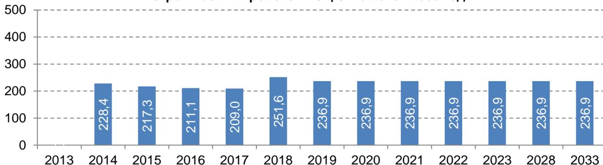
**Рис.1.3.6. Удельные расхода условного топлива на отпуск электроэнергии по ПГУ Кировской ТЭЦ-3 на 2013 - 2033 годы**
