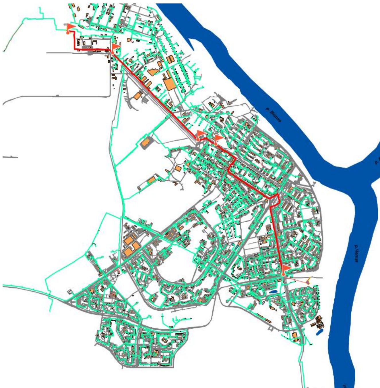
Рис. 2.1.16. Расчетный участок теплосети Кировской ТЭЦ-3 до ТК-4-32
