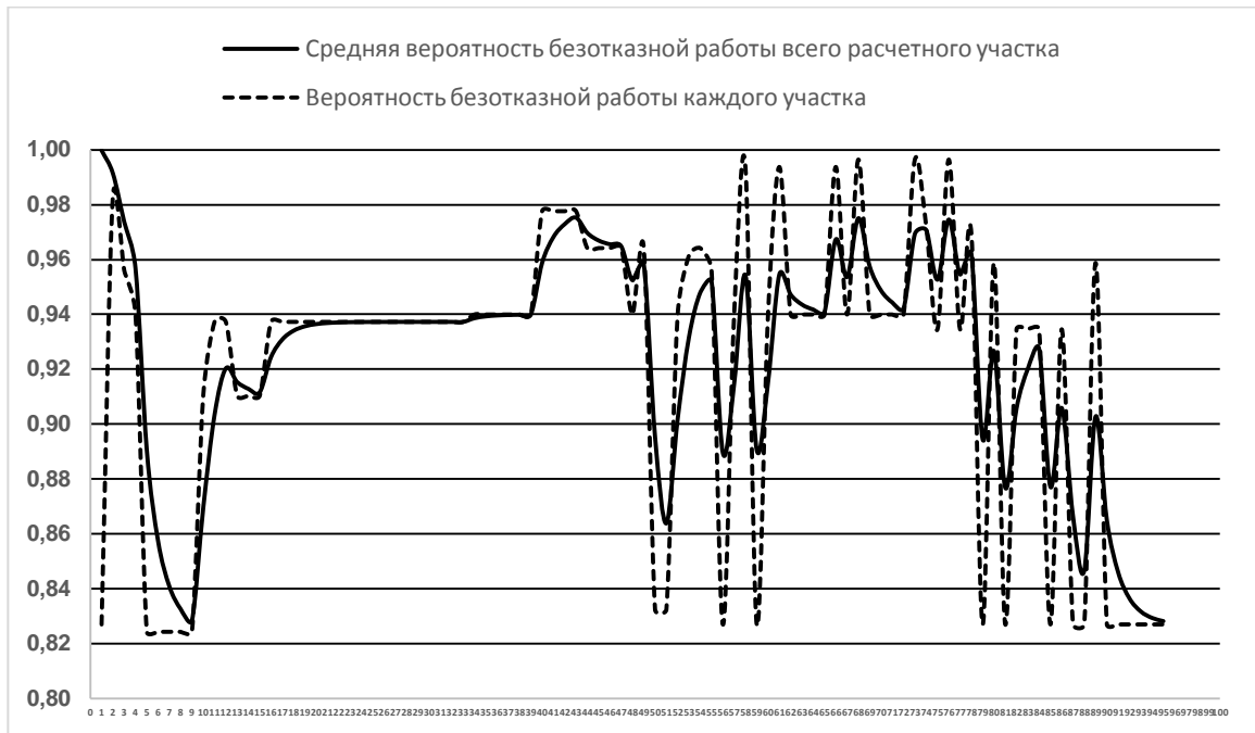
Рис. 2.1.18. Вероятность безаварийной работы тепловой магистрали от ТЭЦ-3 до ТК-4-32 резерв
