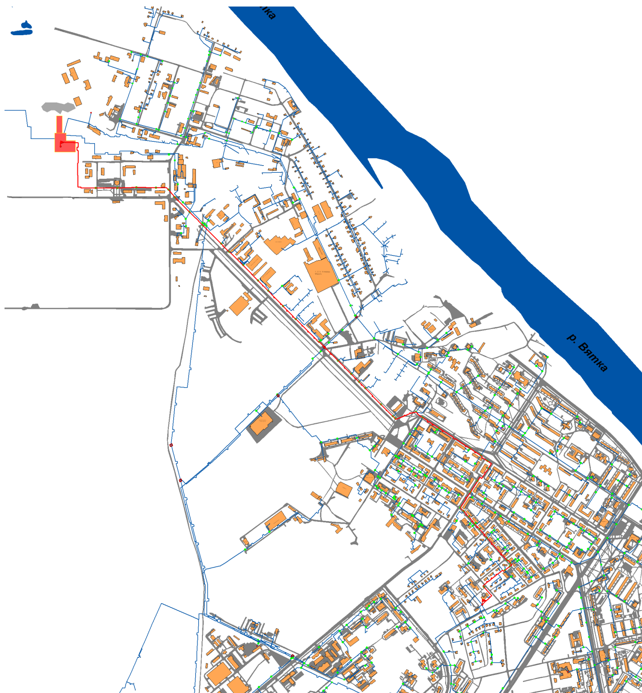
Рис. 2.1.5. Расчетный участок тепловой сети Кировская ТЭЦ-3 – Уз 3-47
