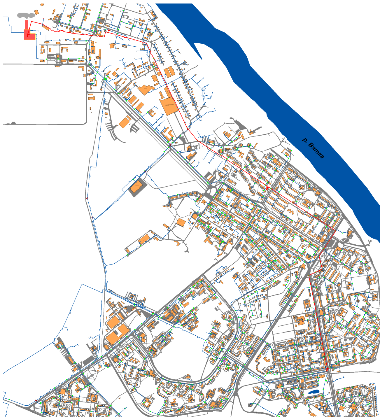
Рис. 2.1.11. Расчетный участок теплосети Кировской ТЭЦ-3 до ТК 5-12
