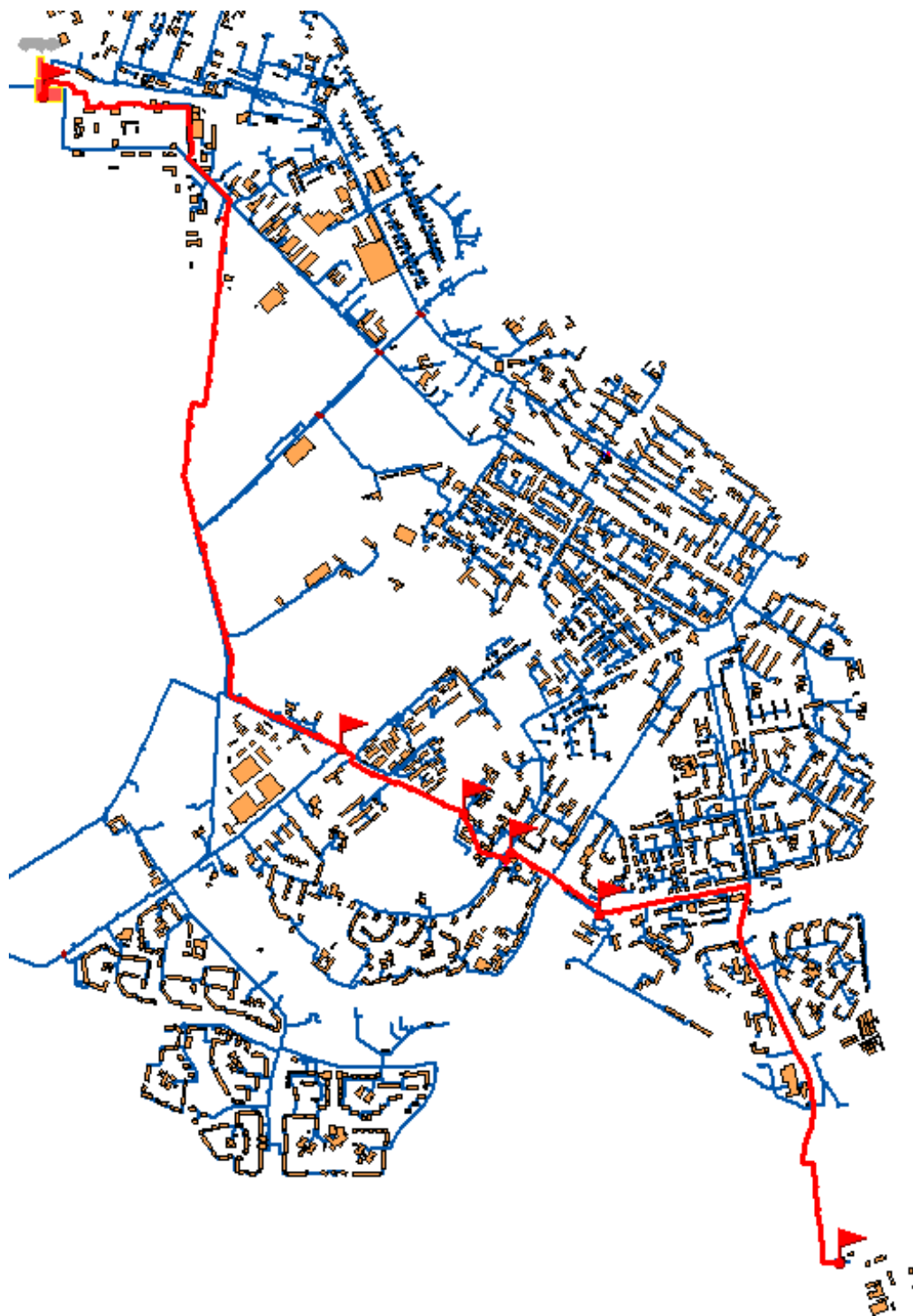
Рис. 2.1.21. Расчетный участок теплосети Кировской ТЭЦ-3 до ТК-5-22
