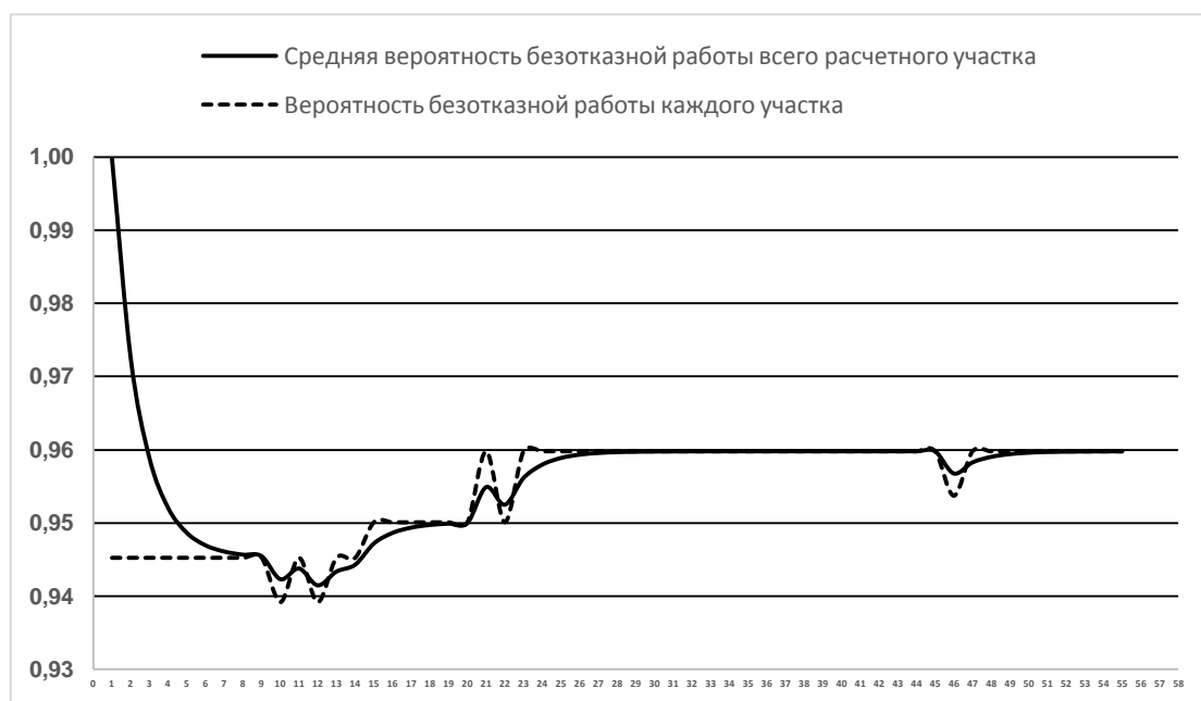
Рис. 2.1.22. Вероятность безаварийной работы тепловой магистрали от Кировской ТЭЦ-3 до ТК-5-22 в 2014 г.
