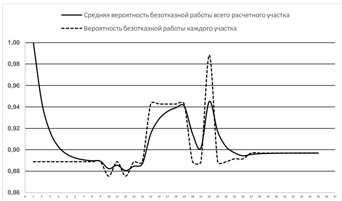
Рис. 2.1.20. Вероятность безаварийной работы тепловой магистрали от Кировской ТЭЦ-3 до 7НО-57 г.
