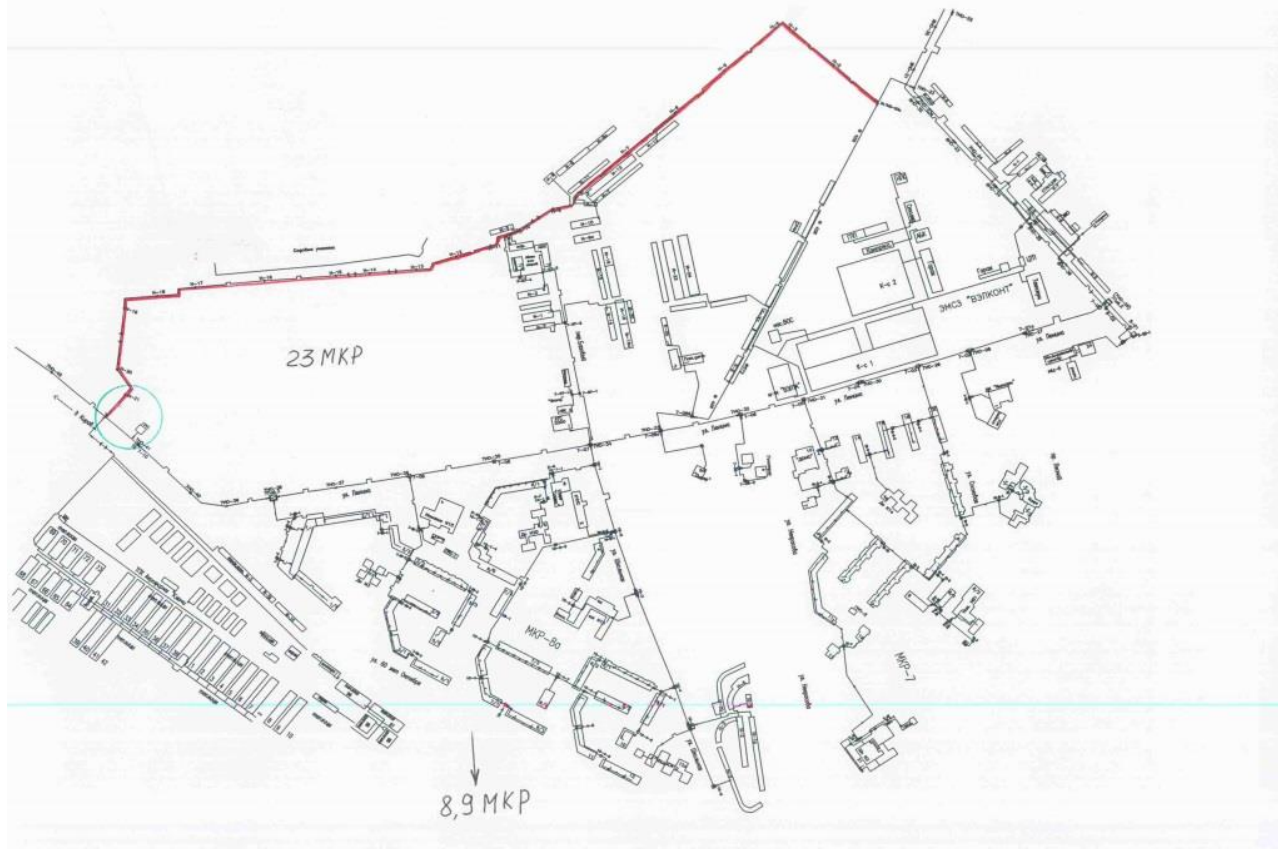
Рис. 2.2.18. Строительство перемычки схемы от тепломагистрали «Чепецкий Тепличный комбинат» до тепломагистралей АО «КТК».
