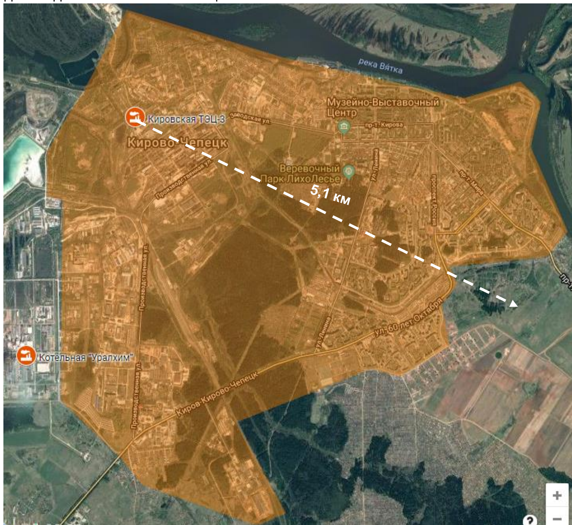
Рис. 2.1.2. Зона действия Кировской ТЭЦ-3 (стрелкой обозначен радиус эффективного теплоснабжения)
