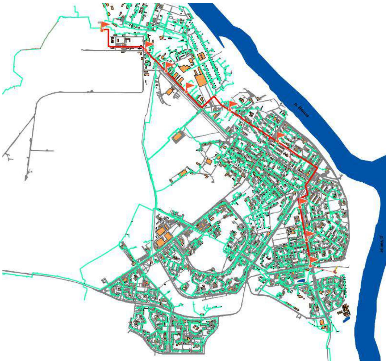
Рис. 2.1.12. Резервный участок теплосети Кировской ТЭЦ-3 до ТК 5-12
