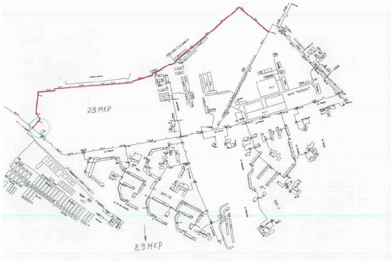
Рис. 2.2.18. Строительство перемычки схемы от тепломагистральной «Чепецкий Тепличный комбинат» до тепломагистралей АО «КТК».
