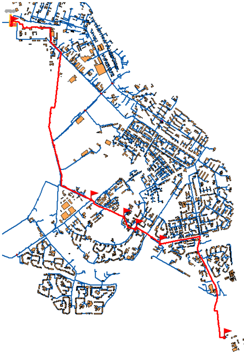
Рис. 9.2.26. Расчетный участок теплосети Кировской ТЭЦ-3 до ТК-5-22
