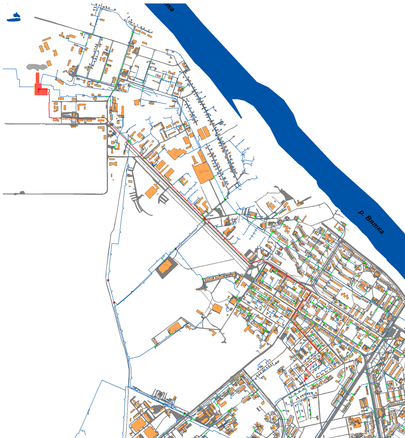
Рис. 9.2.4. Расчетный участок тепловой сети Кировская ТЭЦ-3 – Уз 3-47
