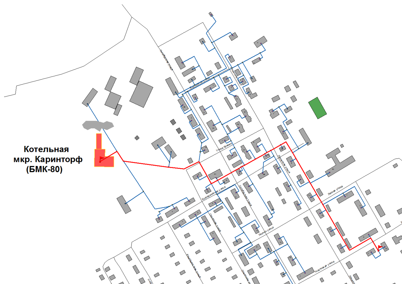
Рис. 3.8.15. Расчетный участок теплосети от котельной мкр. Каринторф
