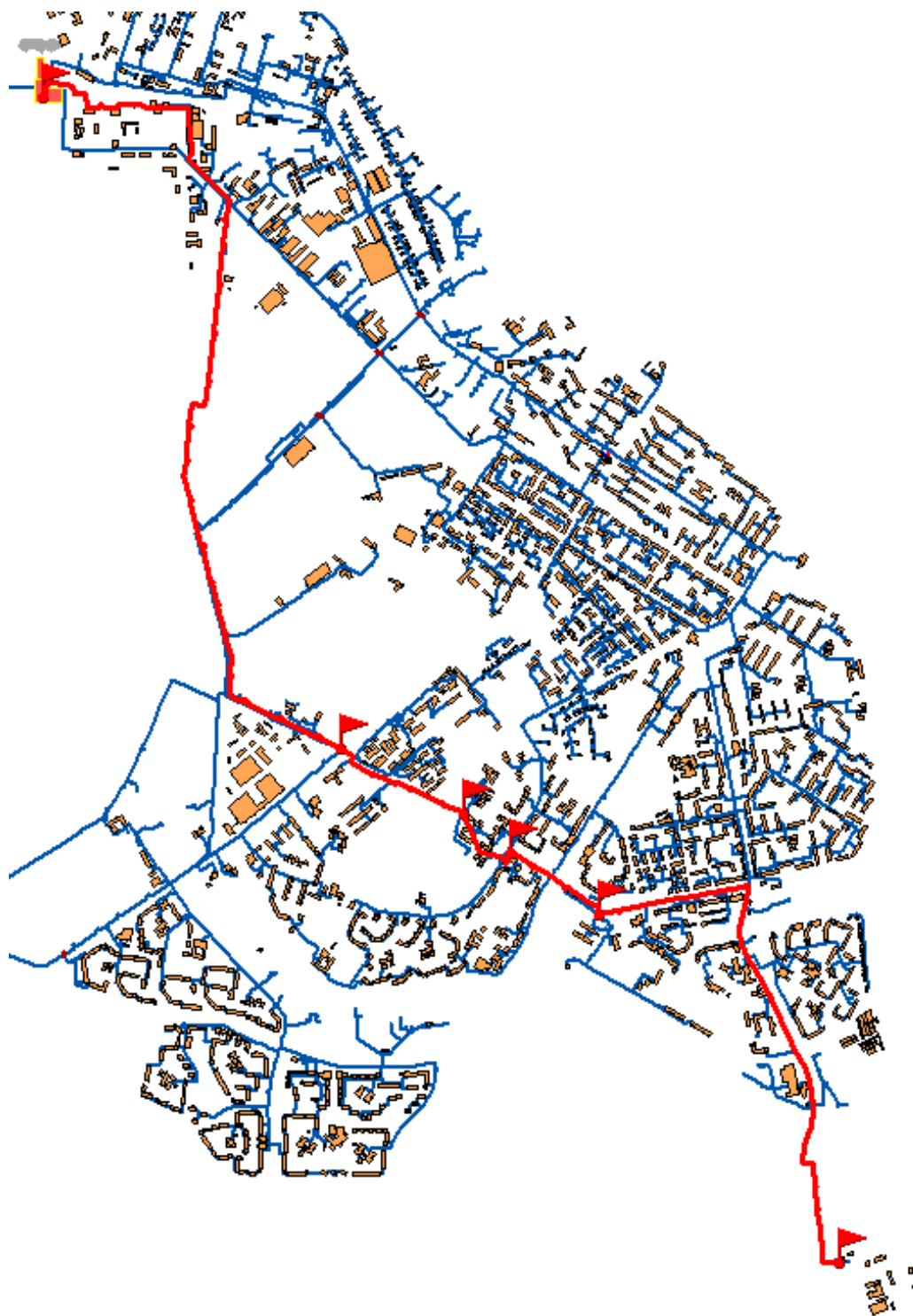
Рис. 2.1.26. Расчетный участок теплосети Кировской ТЭЦ-3 до ТК-5-22
