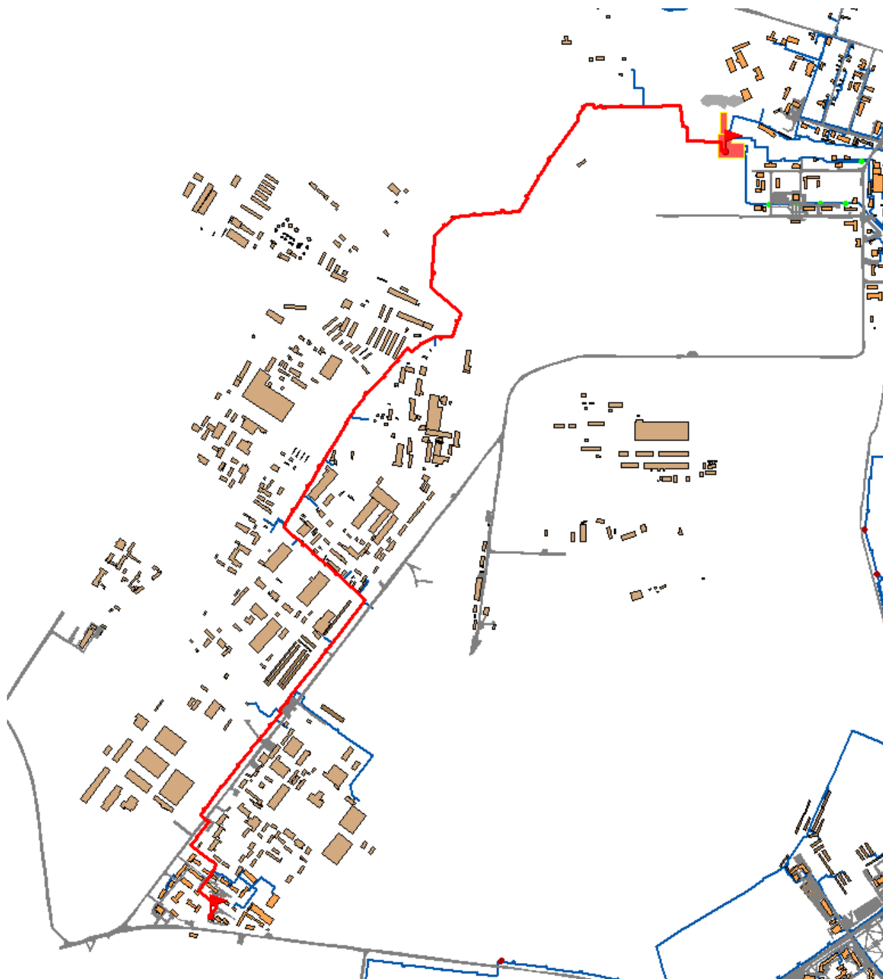
Рис. П 2.5.1. Расчетная схема участка тепловой сети от ТЭЦ-3 до Уз. ПМК-6
