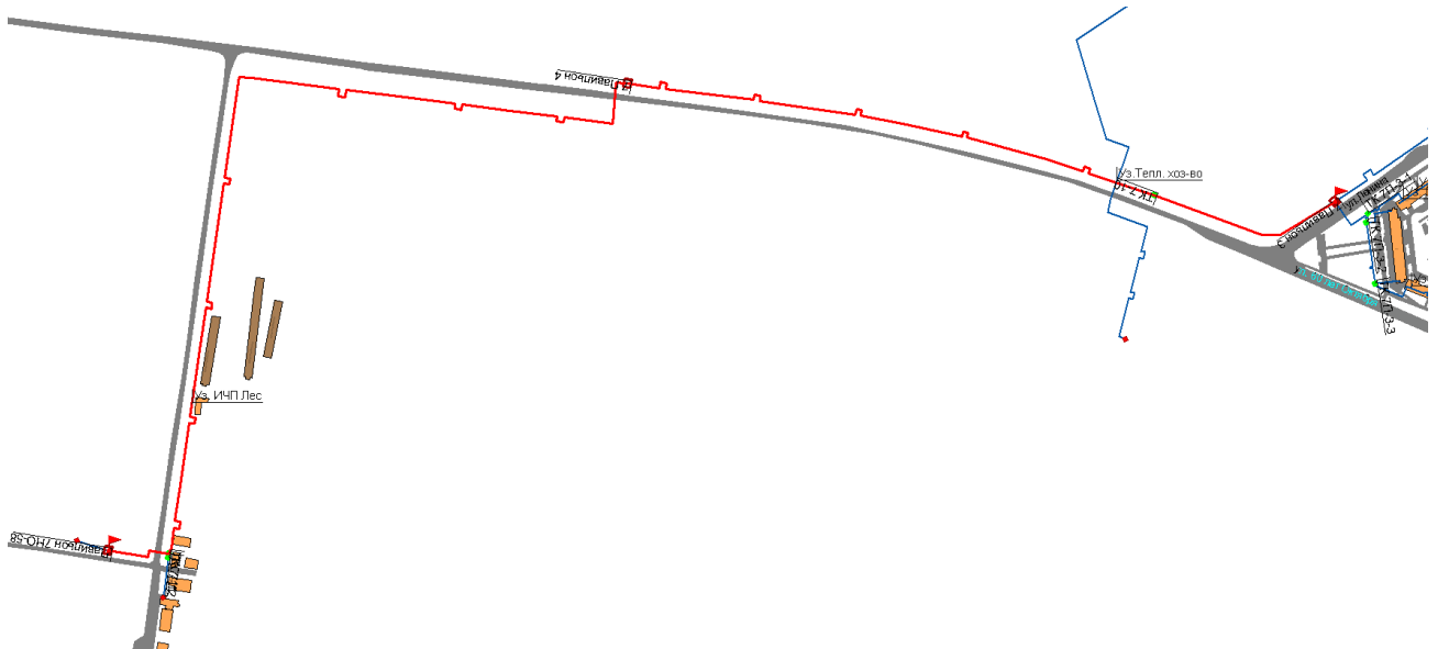
Рис. 4.5. Участок тепломагистрали Ø 500 от 7 ПАВ-3 до 7НО -41
