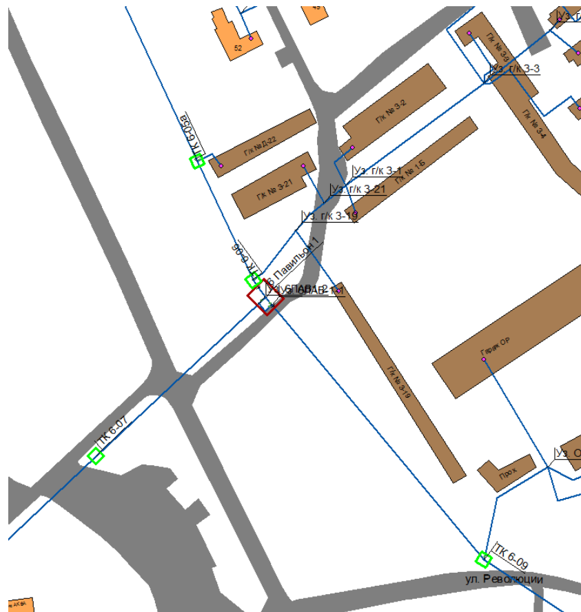
Рис. 4.10. Участок тепломагистрали Ø 600 от опуска между 6НО-30 и 6НО-31 до 6ПАВ-1
