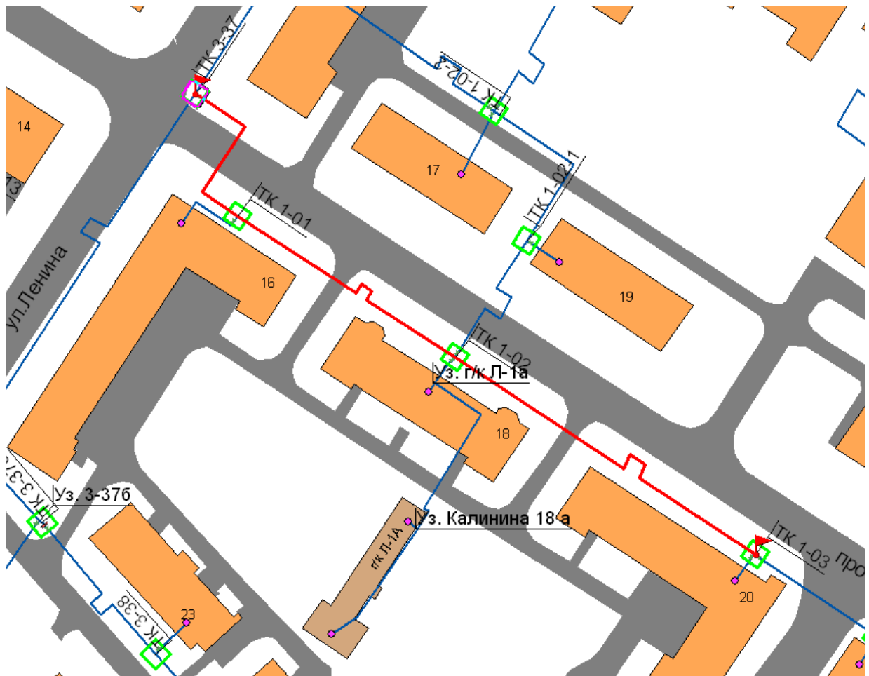
Рис. 4.7. Участок тепломагистрали от ТК 3-37 до ТК 1-03
