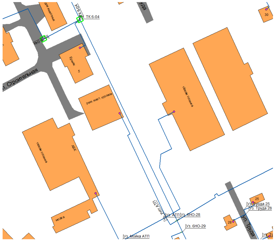
Рис. 4.9 Участок тепломагистрали Ø 600 от 6 НО -25 до 6НО-27
