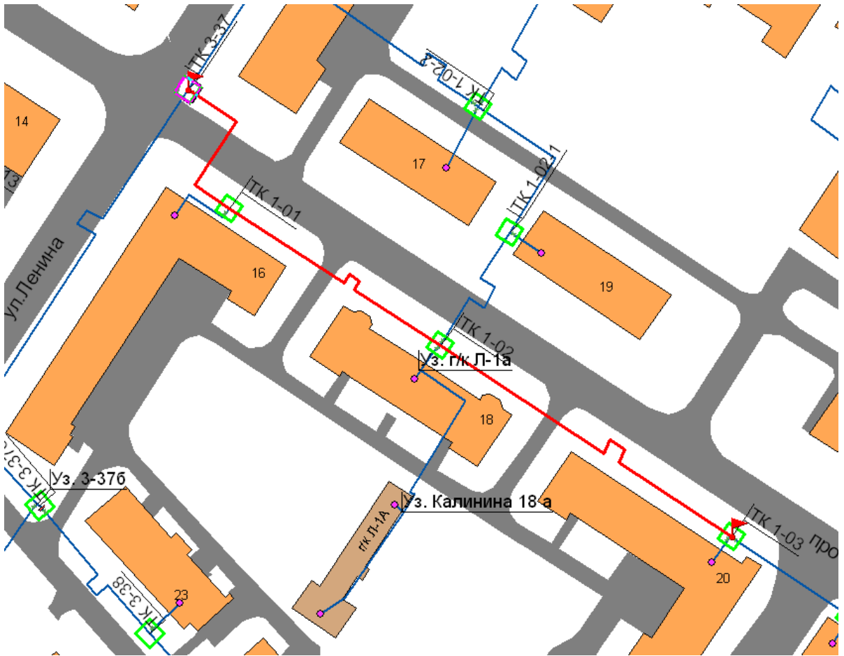
Рис. 2.1.7. Участок теплом магистрали отТК3-37 до ТК 1-03
