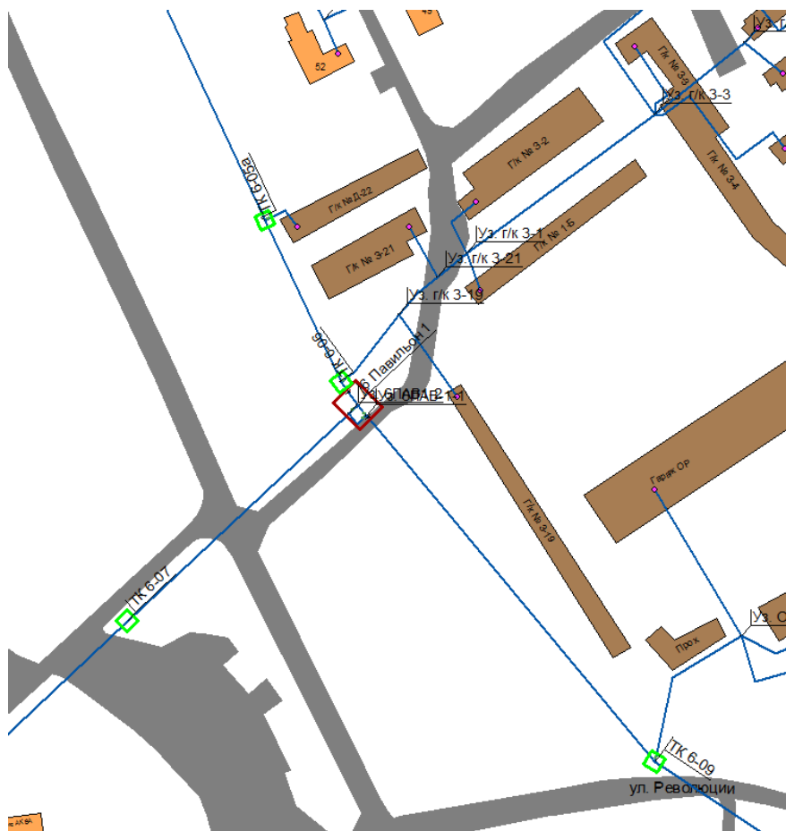
Рис. 2.1.10. Участок тепломагистрали Ø 600 от отпуска между 6НО-30 и 6НО-31 до 6ПАВ-1
