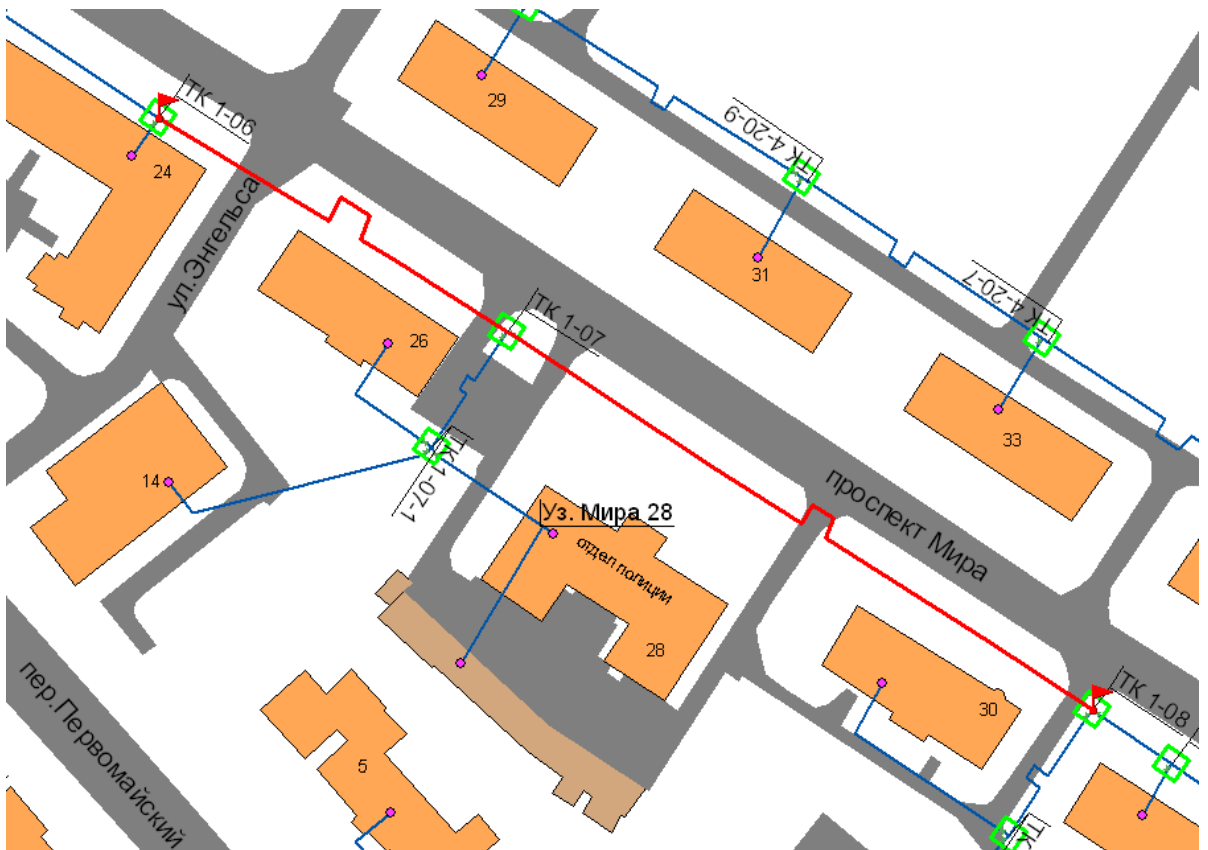
Рис. 2.1.8. Участок теплом магистрали отТК1-06 до ТК 1-08
