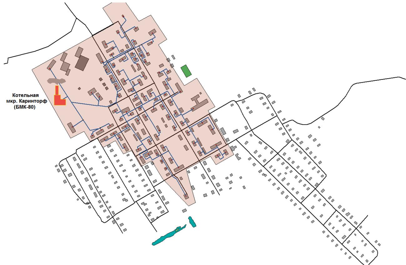
**Рис. 2.1.2. Зона действия котельной микрорайона Каринторф (выделена красным)
