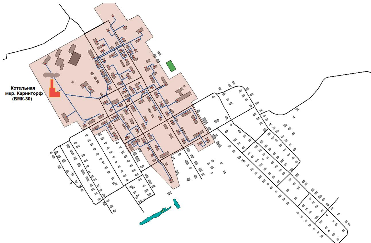
**Рис. 2.1.2. Зона действия котельной микрорайона Каринторф (выделена красным) с указанием тепловых сетей (выделены синим)**
