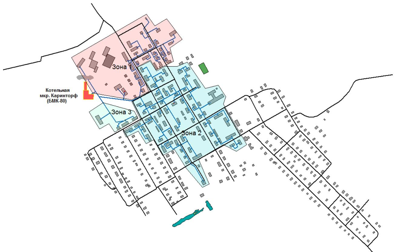
Рис. 2.5.2. Расчетная схема для определения эффективного радиуса теплоснабжения
