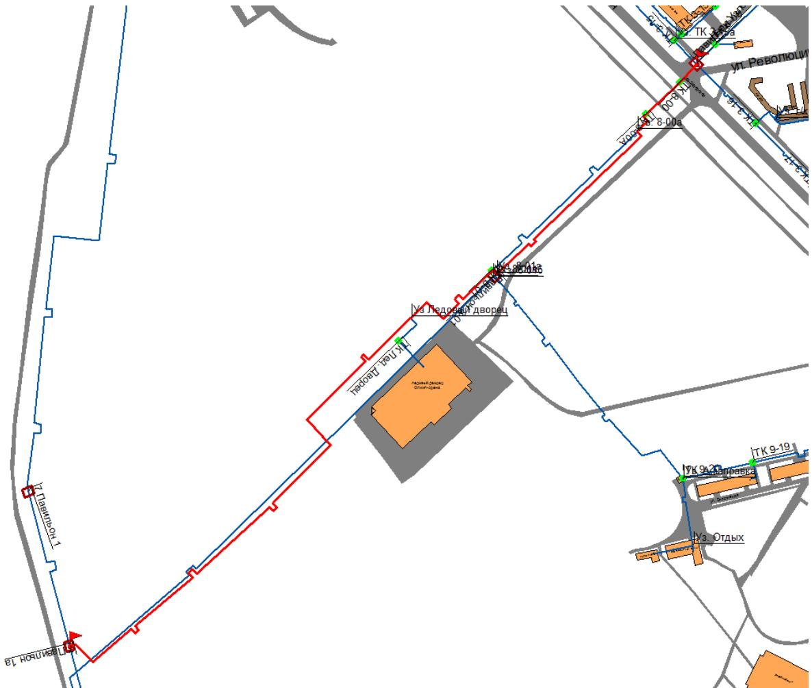
**Рис. 5.2.29. Реконструкция перемычки между магистралями Ø 350 (узловая) и Ø 700 (7ПАВ-1А)**
