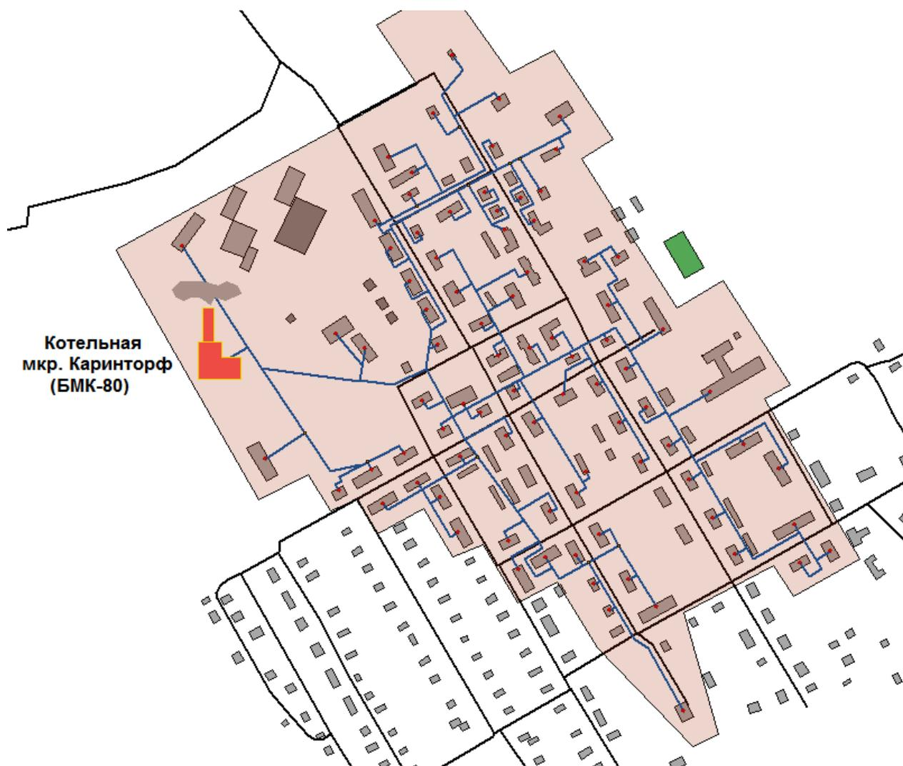
Рис. 8.1.2. Зона действия котельной мкр. Каринторфф
