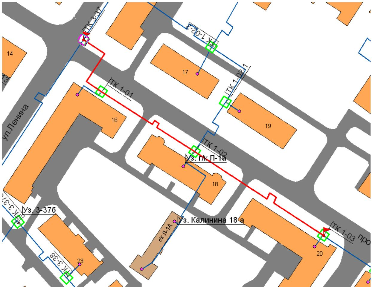
Рис. 5.2.7. Участок тепломagистрaли отTK3-37 до TK 1-03
