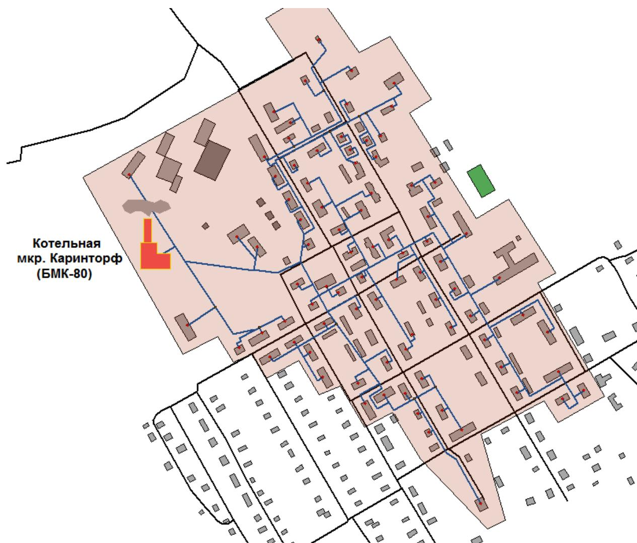
Рис. 8.1.2. Зона действия котельной мкр. Каринторф
