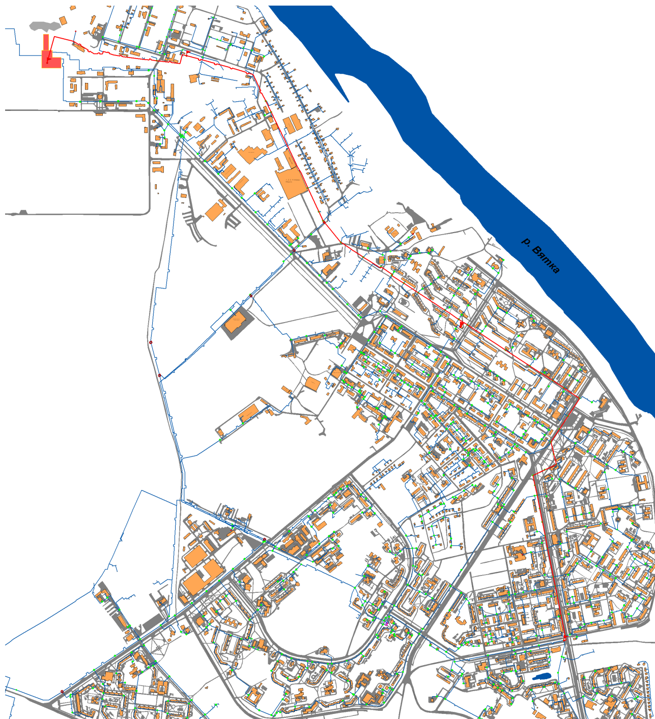
Рис. 2.1.11. Расчетный участок теплосети Кировской ТЭЦ-3 до ТК 5-12
