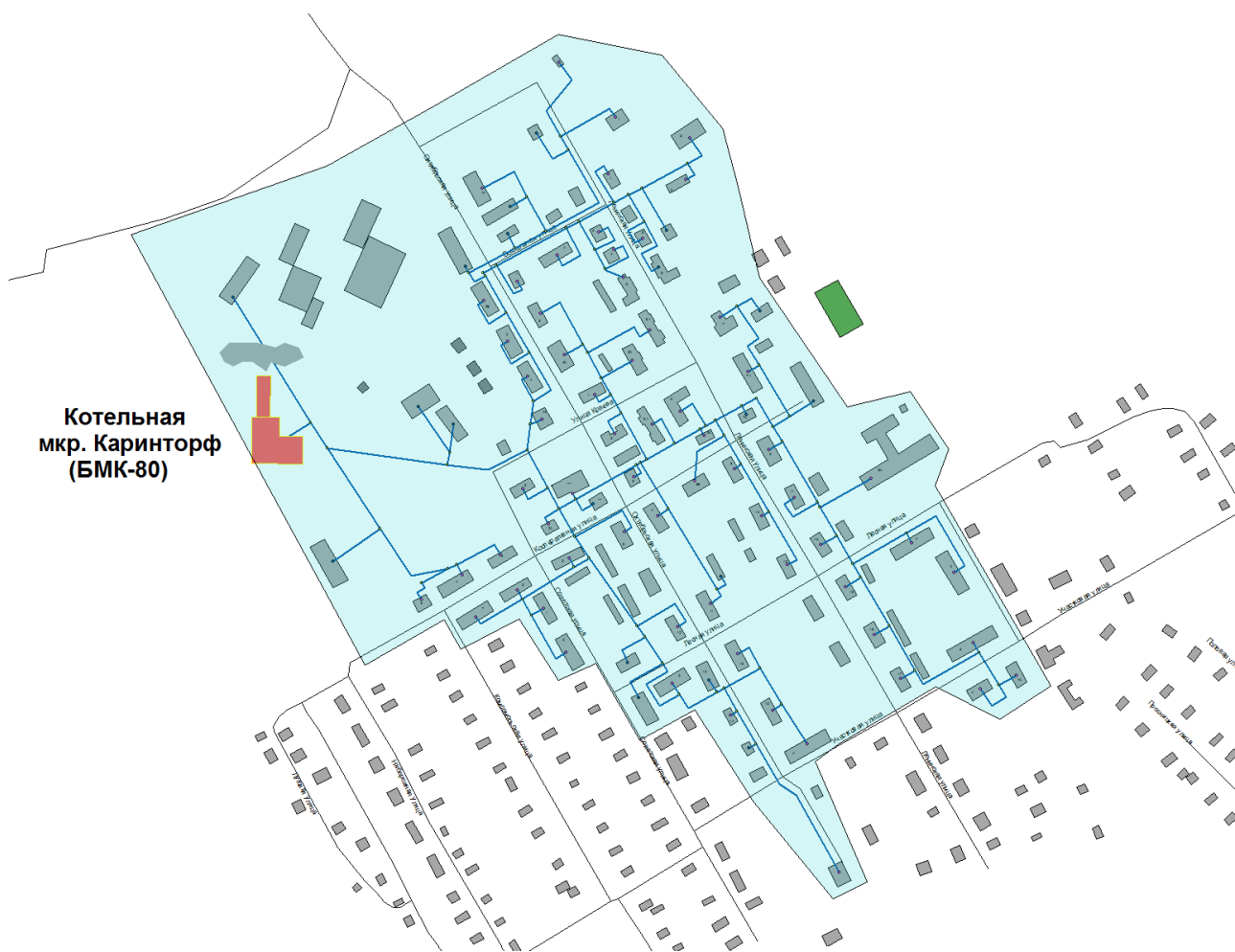
Рис. 1.2.1. Зона эксплуатационной ответственности котельной БМК-8,0 микрорайона Каринторф
