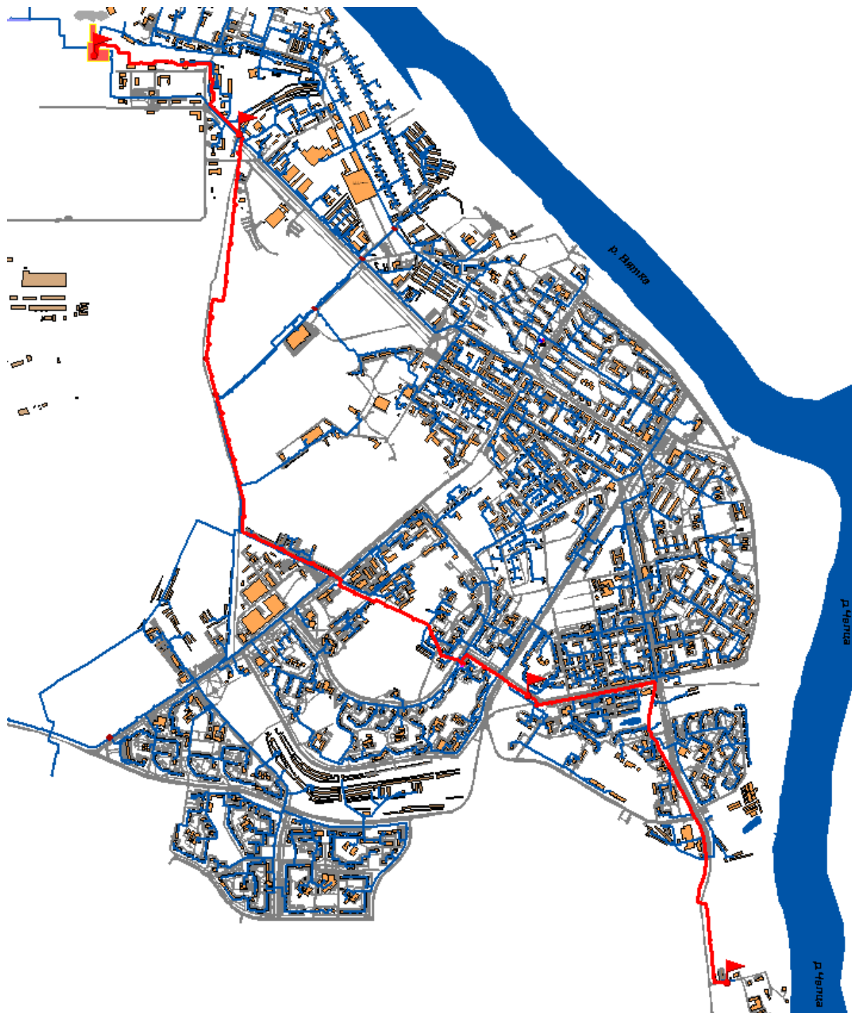
Рис. П 2.6.13. Расчетная схема участка тепловой сети от ТЭЦ-3 до ТК 5-22
