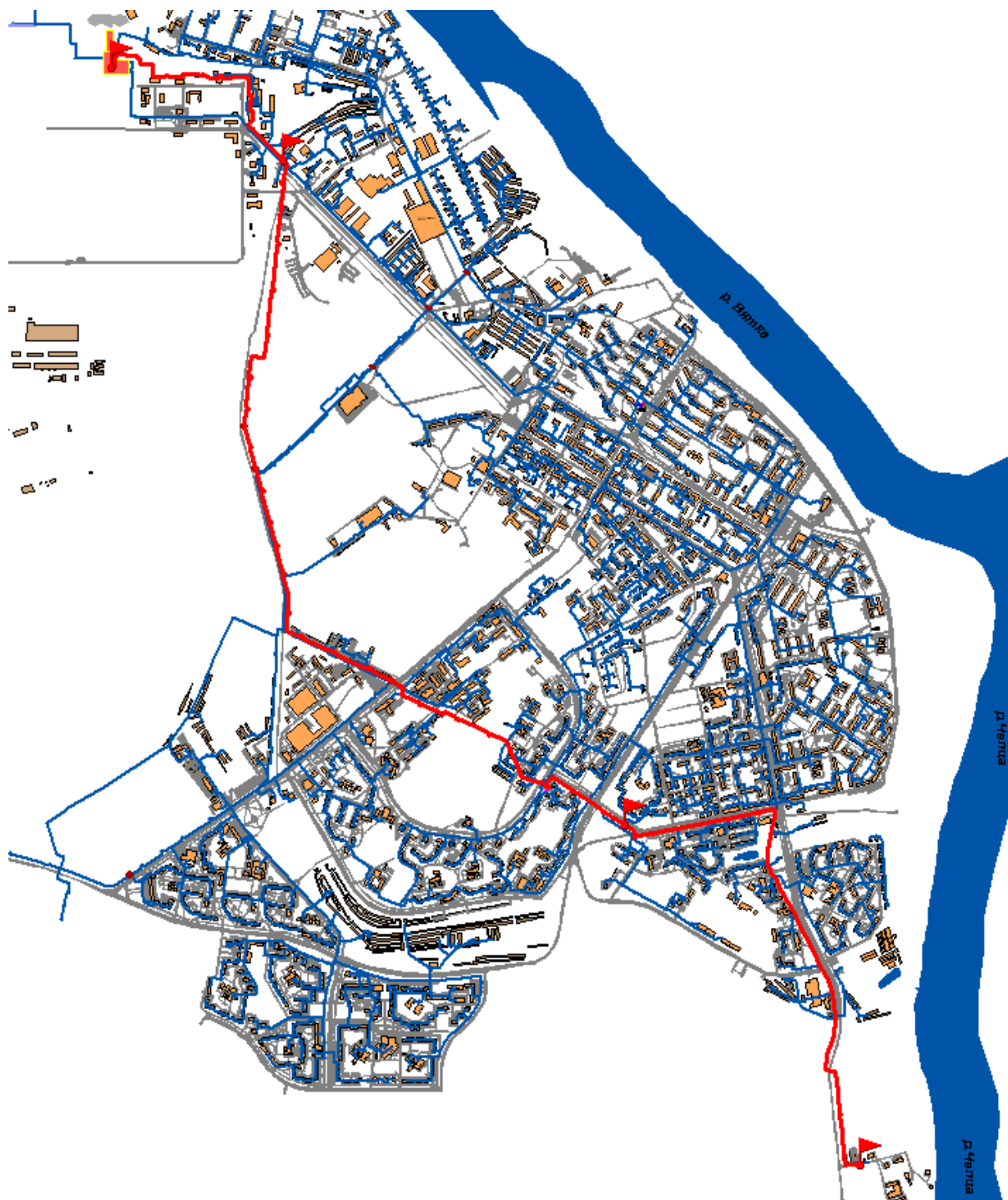
Рис. П 2.3.13. Расчетная схема участка тепловой сети от ТЭЦ-3 до ТК 5-22
