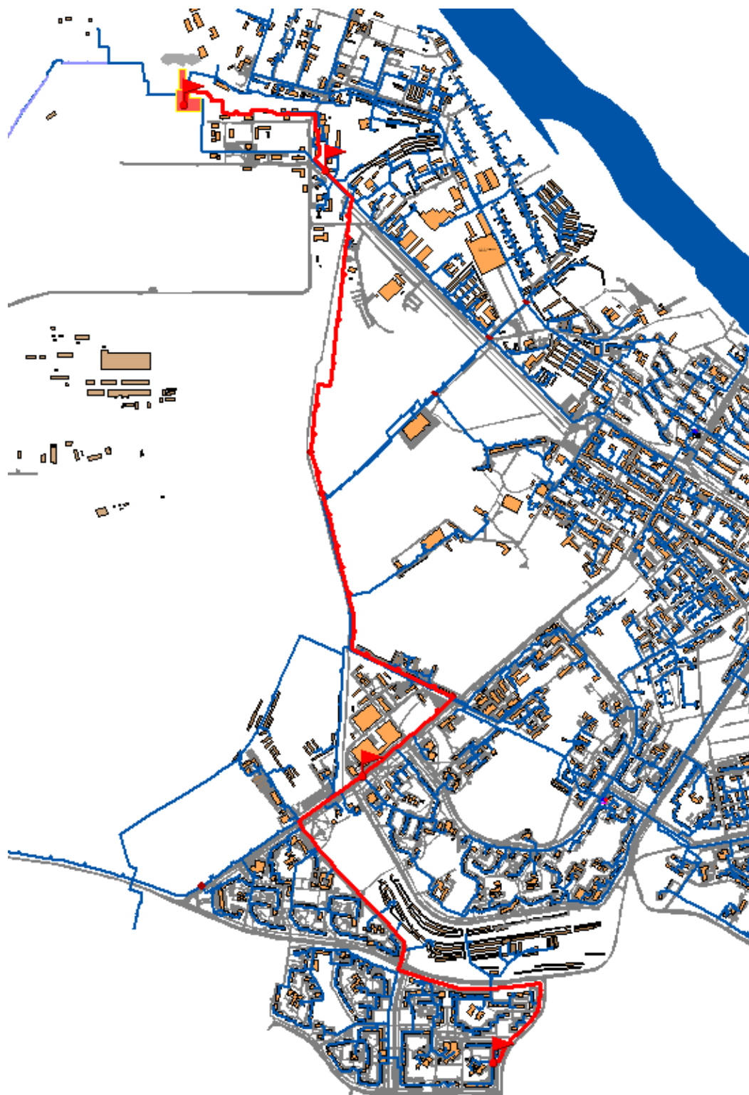
Рис. П 2.3.11. Расчетная схема участка тепловой сети от ТЭЦ-3 до ул. Победы 11
