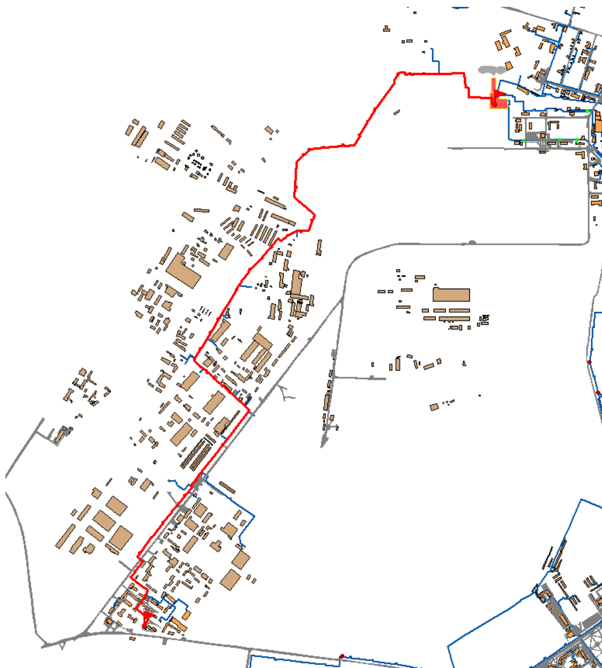
Рис. П 2.1.1. Расчетная схема участка тепловой сети от ТЭЦ-3 до Уз. ПМК-6
