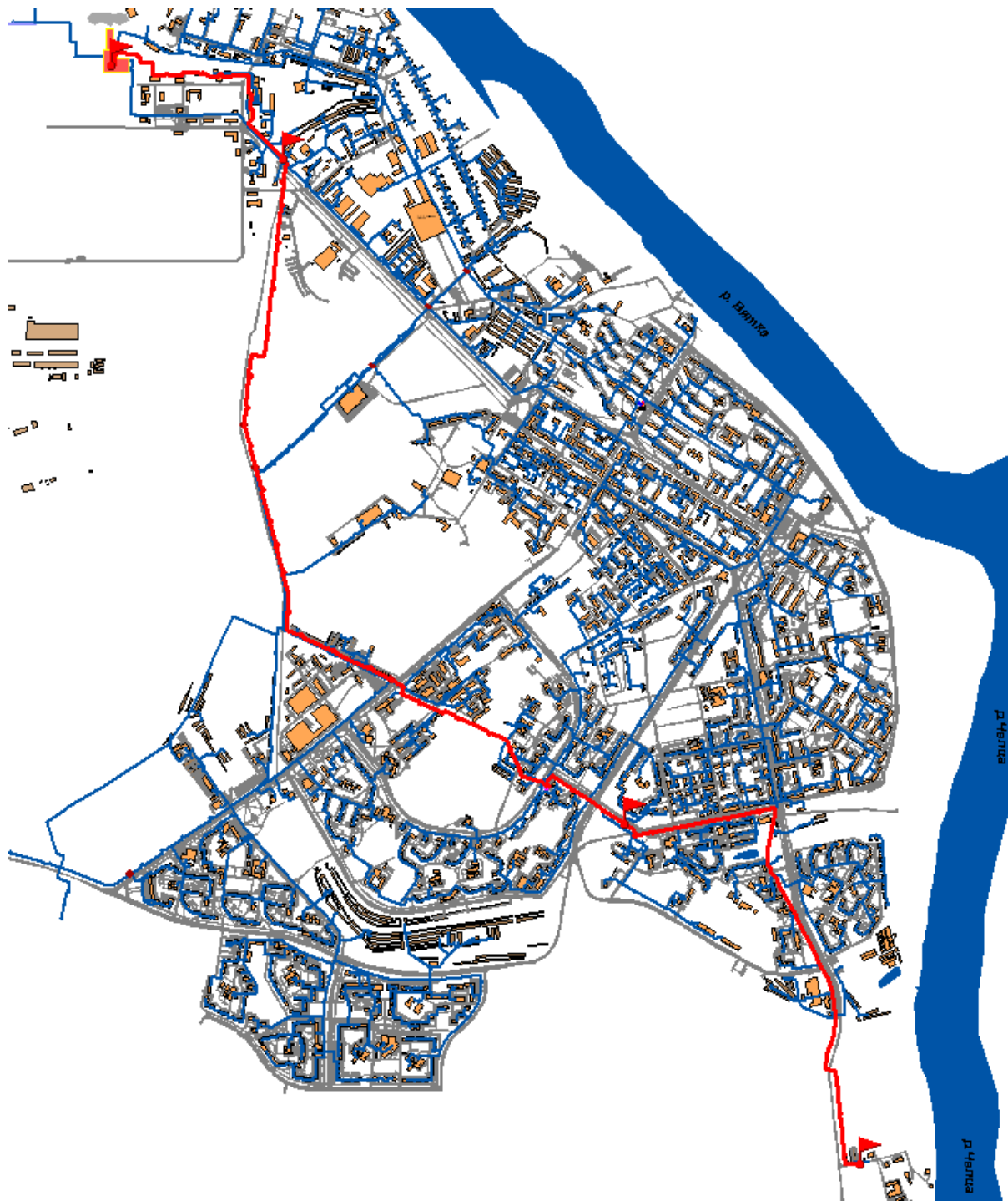
Рис. 2.2.13. Расчетная схема участка тепловой сети от ТЭЦ-3 до ТК 5-22
