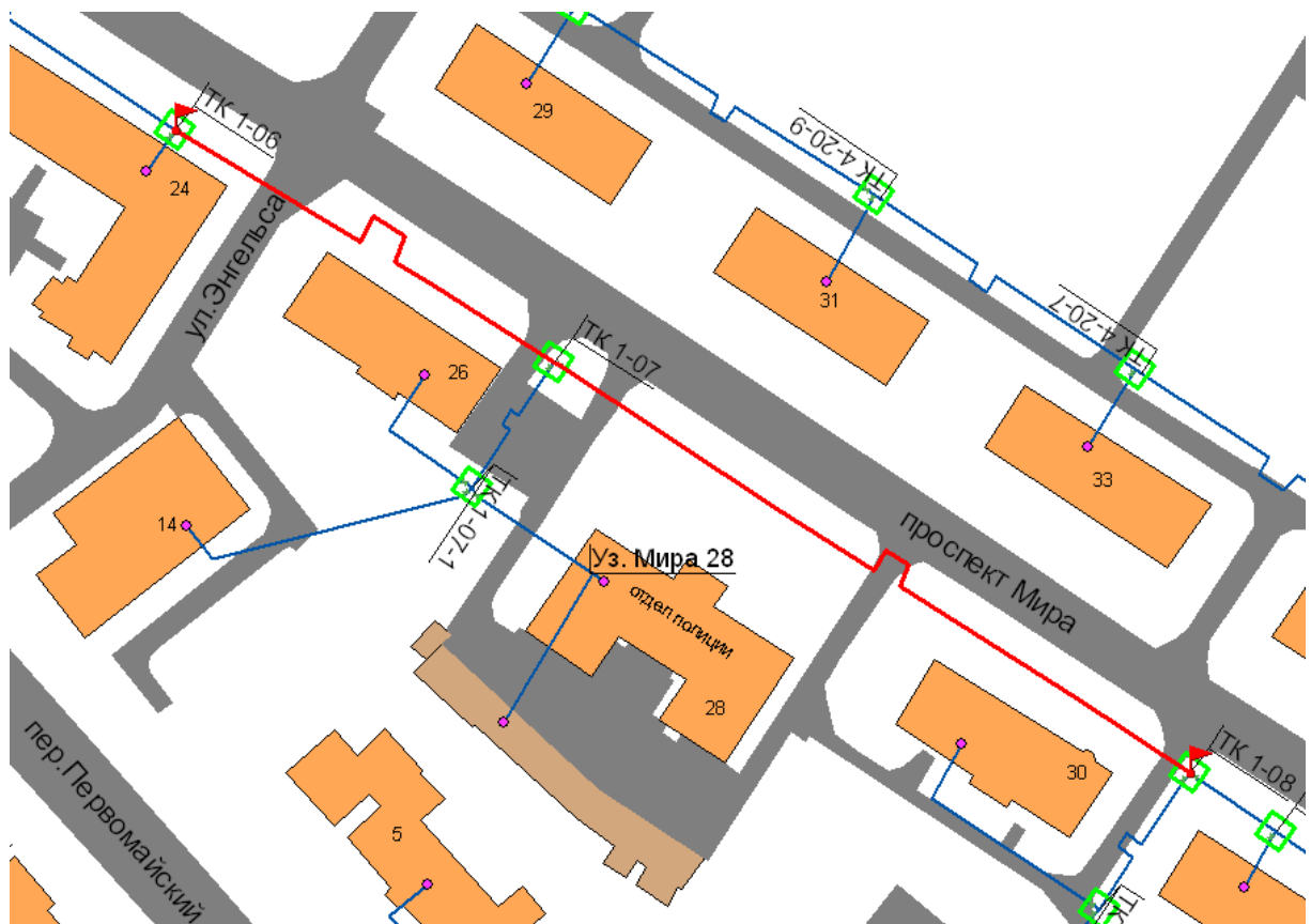
Рис. 4.8. Участок тепломагистрали отТК1-06 до ТК 1-08
