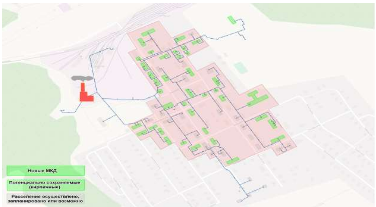
Рисунок 3.1 – Зона теплоснабжения котельной Каринторф после ожидаемого расселения
