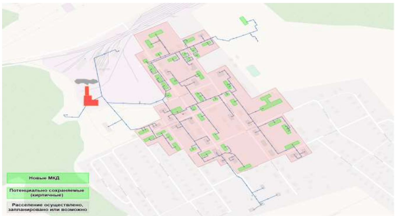
Рисунок 4.3 – Зона теплоснабжения котельной Каринторф после ожидаемого расселения
