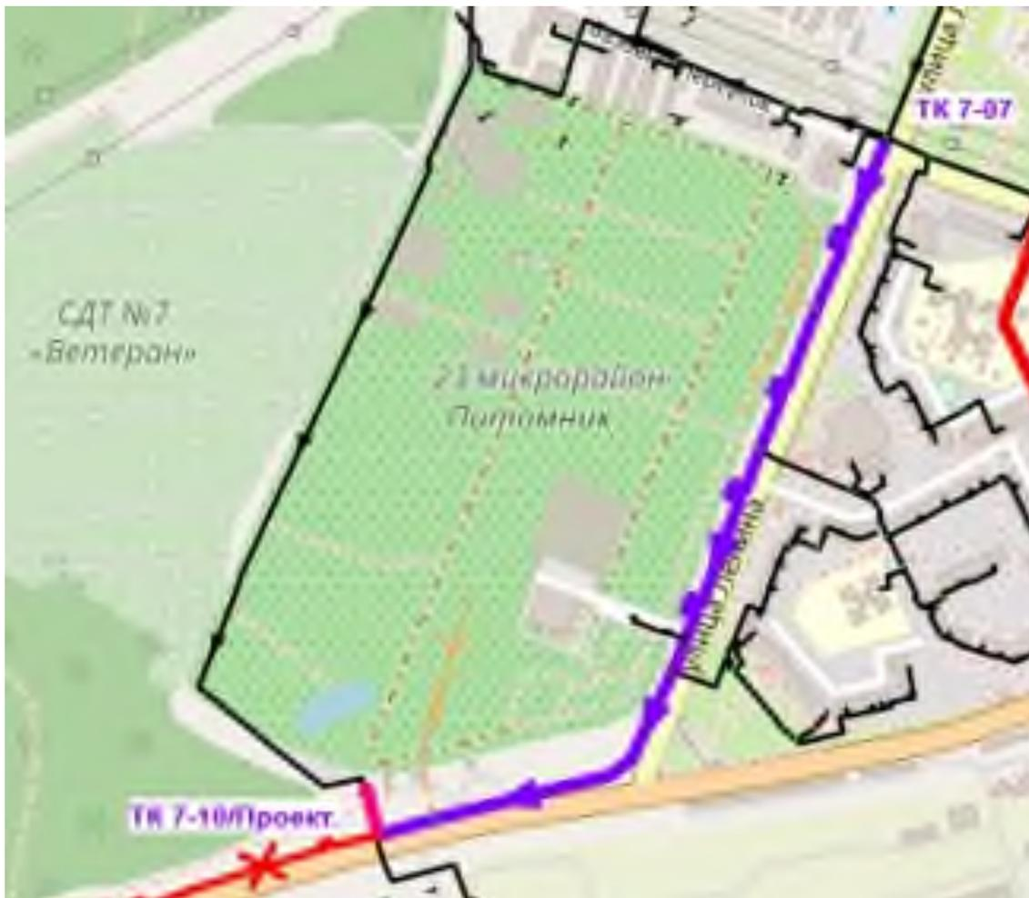
**Рисунок 4 – Реконструкция с уменьшением диаметра трубопроводов участков тепловых сетей Ду600-500 мм на Ду250-200 мм от ТК 7-07 до пересечения с магистралью ООО «СХП Тепличный комбинат»**
