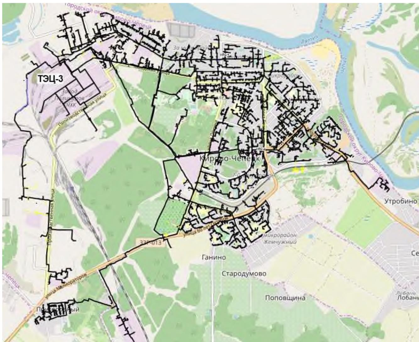
Рисунок 7 – Схема тепловых сетей от ТЭЦ-3
