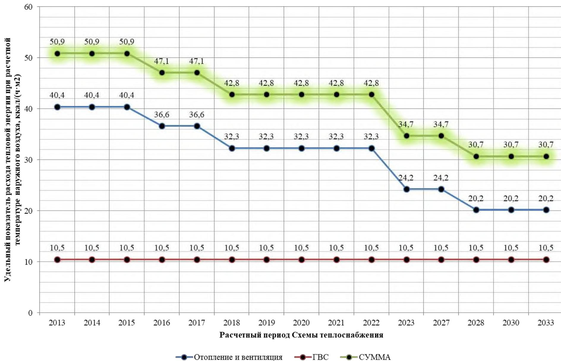
Рисунок 9 - Изменение нормируемого удельного расхода тепловой энергии на отопление, вентиляцию и ГВС на примере жилого 12-этажного многоквартирного дома
