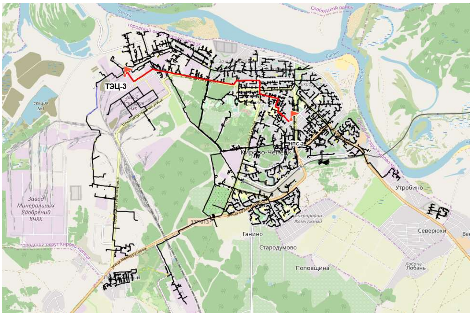
Рисунок 4.10 – Путь движения теплоносителя от источника тепловой энергии до конечного потребителя, в зоне действия ТЭЦ №3 (центральная часть) (рисунок П46.1 МУ)
