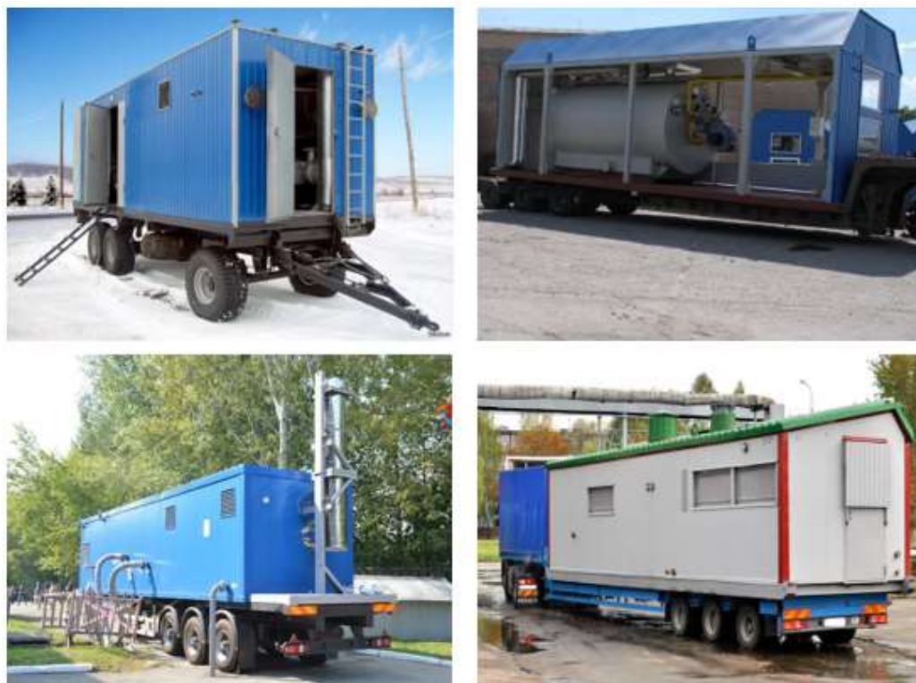
Рисунок 8.1 – Внешний вид передвижных котельных установок
