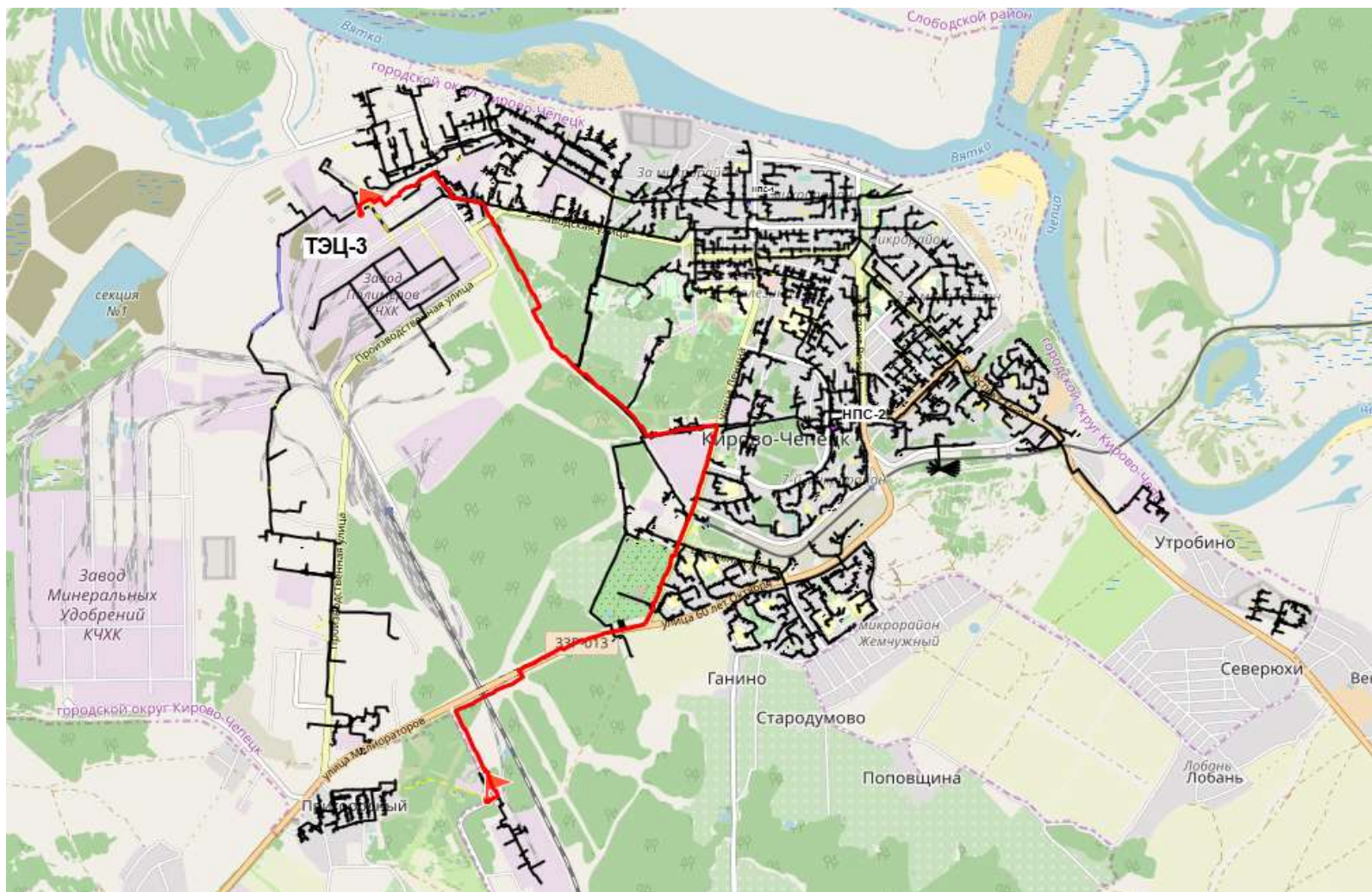
Рисунок 4.6 – Путь движения теплоносителя от источника тепловой энергии до конечного потребителя, в зоне действия котельной ТЭЦ №3 (Пригородный) (рисунок П46.1 МУ)
