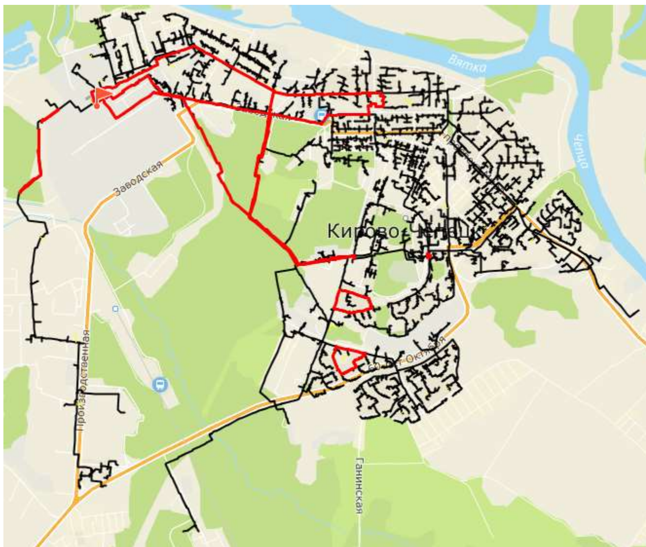
Рисунок 9.3 - Кольцовки тепловых сетей в зоне действия ТЭЦ-3
