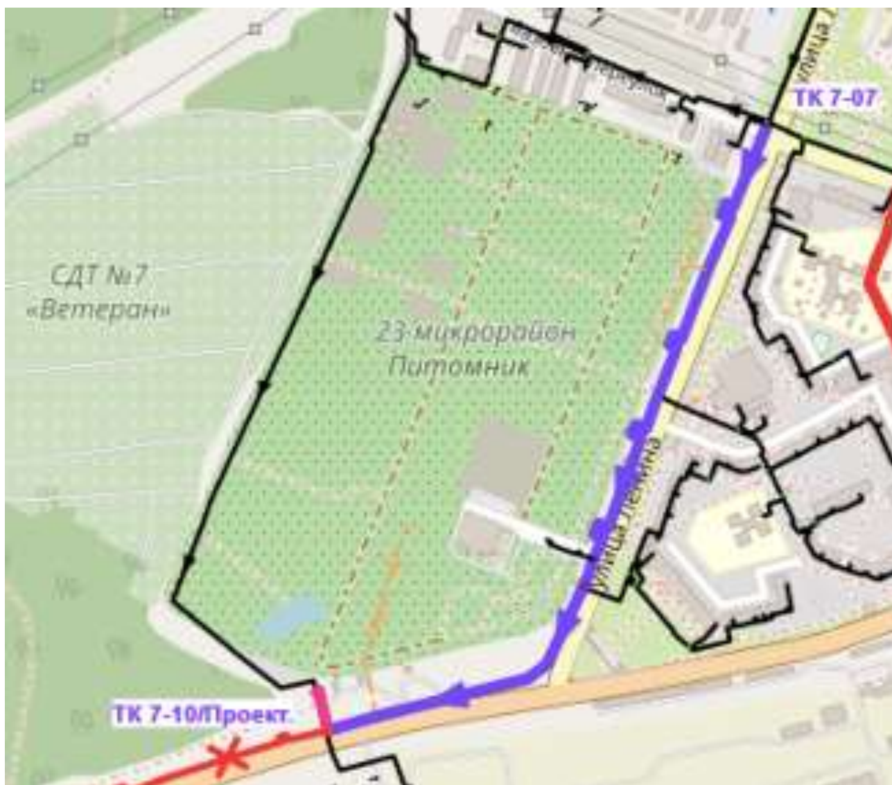
Рисунок 6.2 – Реконструкция с уменьшением диаметра трубопроводов участков тепловых сетей Ду600-500 мм на Ду250-200 мм от ТК 7-07 до пересечения с магистралью ООО «СХП Тепличный комбинат»
