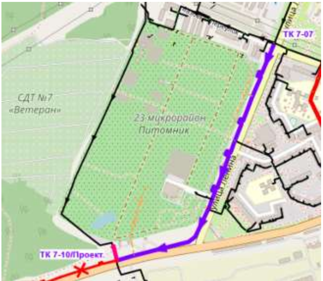
Рисунок 6.4 – Реконструкция с уменьшением диаметра трубопроводов участков тепловых сетей Ду600-500 мм на Ду250-200 мм от ТК 7-07 до пересечения с магистралью ООО «СХП Тепличный комбинат»
