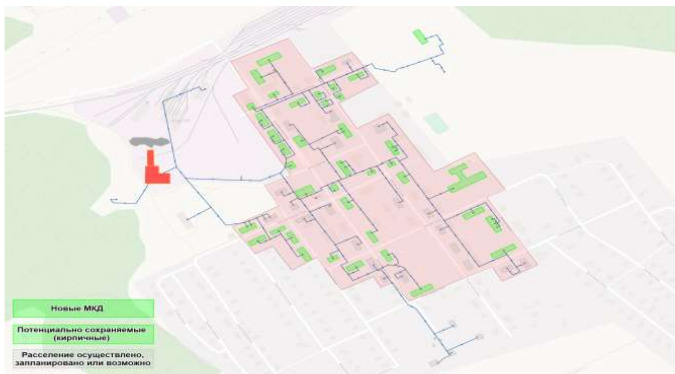
Рисунок 4.3 – Зона теплоснабжения котельной Каринторф после ожидаемого расселения
