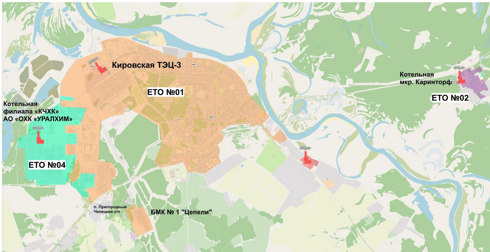
Рисунок 15.1. Зоны действия единых теплоснабжающих организаций г. Кирова-Чепецка с учетом изменений относительно утвержденной схемы теплоснабжения
