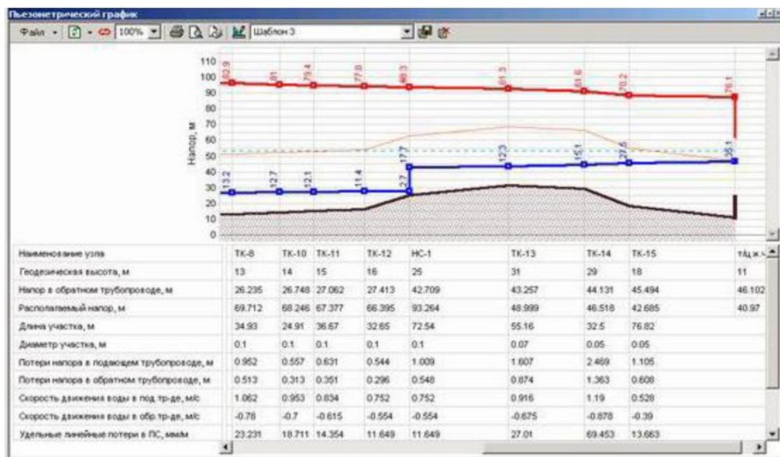
**Рисунок 3.23 – Пьезометрический график**
