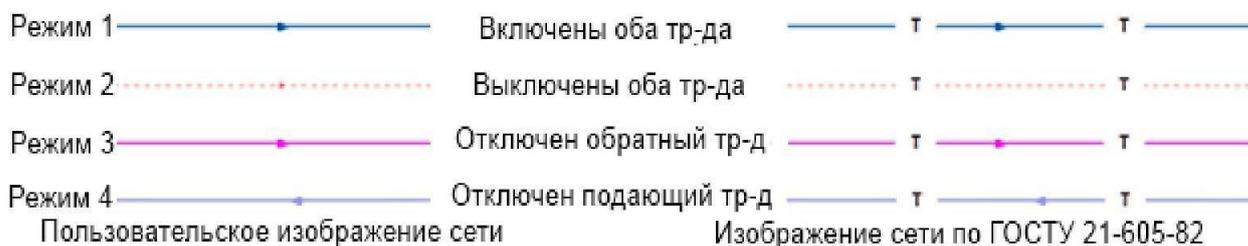
**Рисунок 3.2 – Изображение нескольких состояний участков, задаваемых разными режимами**
