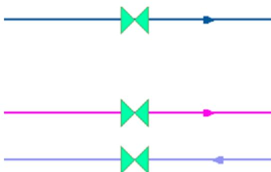
**Рисунок 3.10 – Однолинейное и внутренне представление задвижки**
