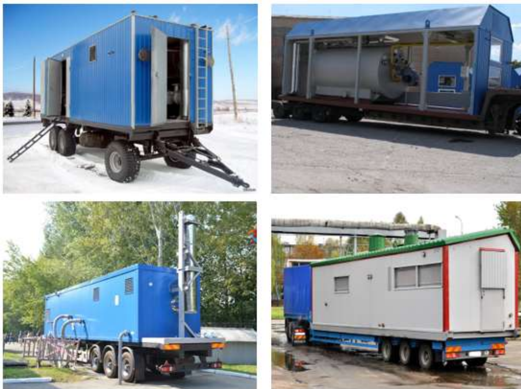
Рисунок 11.2. Внешний вид передвижных котельных установок
