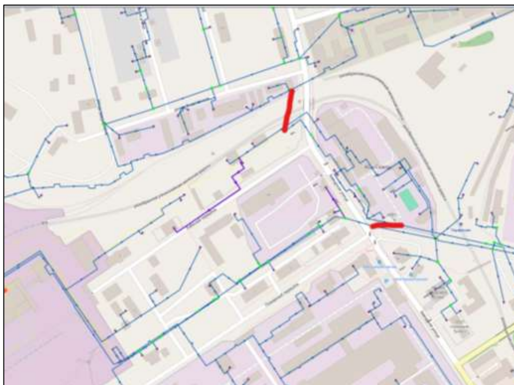
Рисунок 11.8. Строительство дополнительных перемычек для компенсации отключенного головного участка Ду 700 мм
