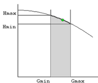
Рисунок 3.16 – Напорно-расходная характеристика насоса
