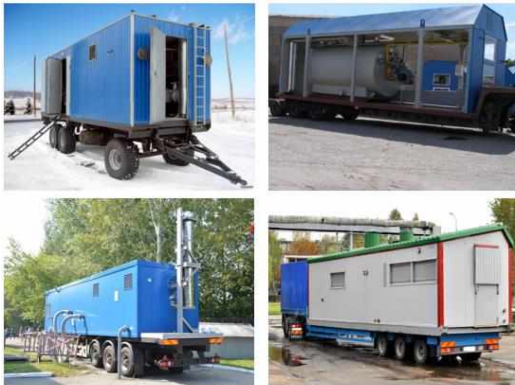
Рисунок 11.3. Внешний вид передвижных котельных установок
