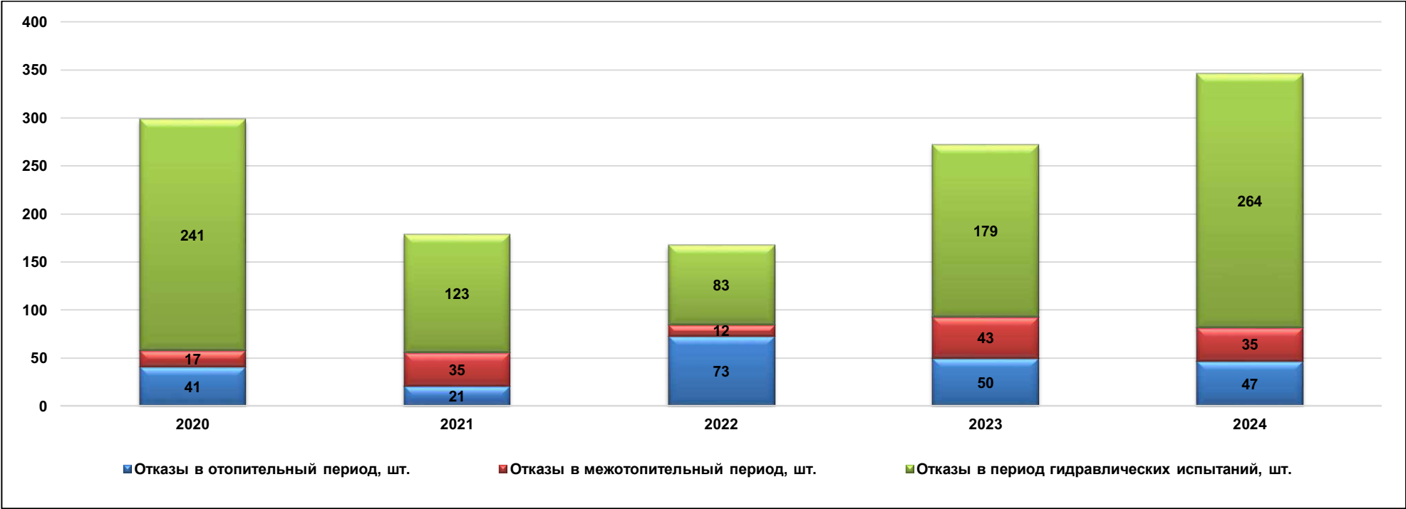
Рисунок 11.1. Статистика повреждаемости трубопроводов тепловых сетей от источников тепловой энергии г. Кирово-Чепецк за 2020 – 2024 гг
