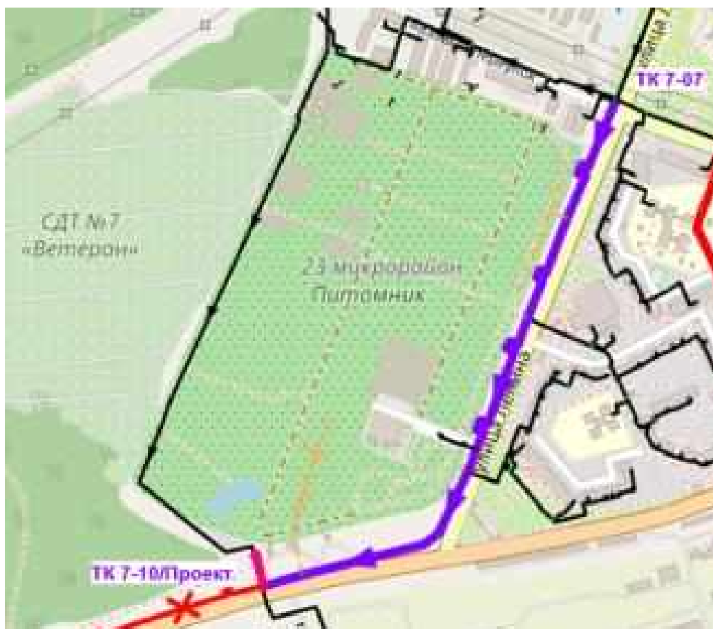
Рисунок 8.4. Реконструкция с уменьшением диаметра трубопроводов участков тепловых сетей Ду600-500 мм на Ду250-200 мм от ТК 7-07 до пересечения с магистралью ООО «СХП Тепличный комбинат»
