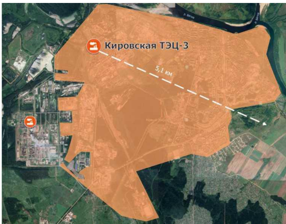
Рисунок 4 – Радиус эффективного теплоснабжения Кировской ТЭЦ-3
