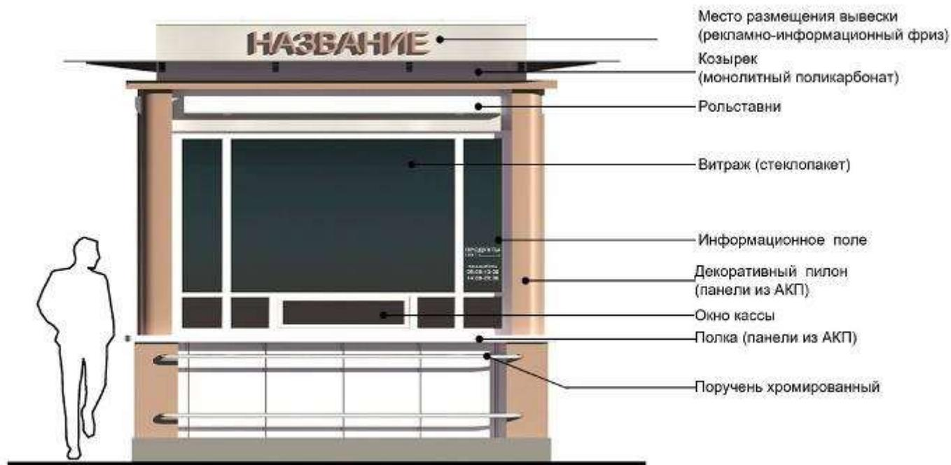
Конструктив: металлический каркас, стеновой наполнитель (сэндвич-панели АКП), стеклопакеты.
