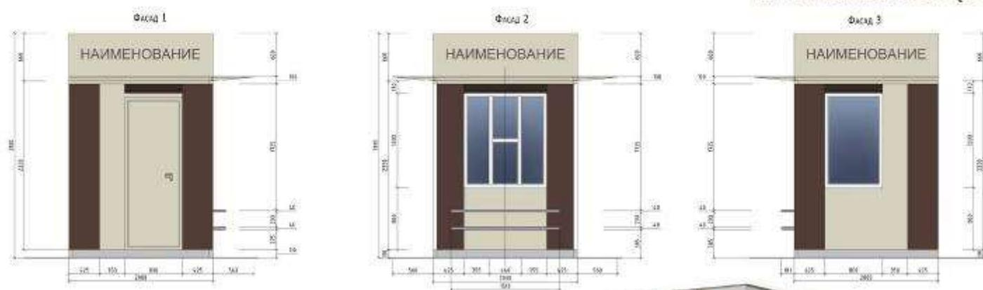
Конструктив: металлический каркас, стеновой наполнитель (сэндвич-панели), стеклопакеты.
