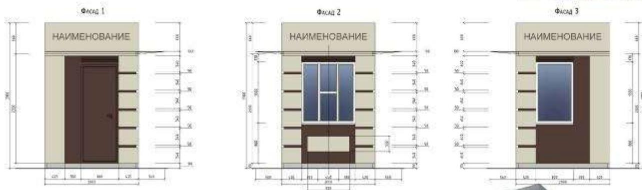
**Конструктив:** металлический каркас, стеновой наполнитель (сэндвич-панели), стеклопакеты.
