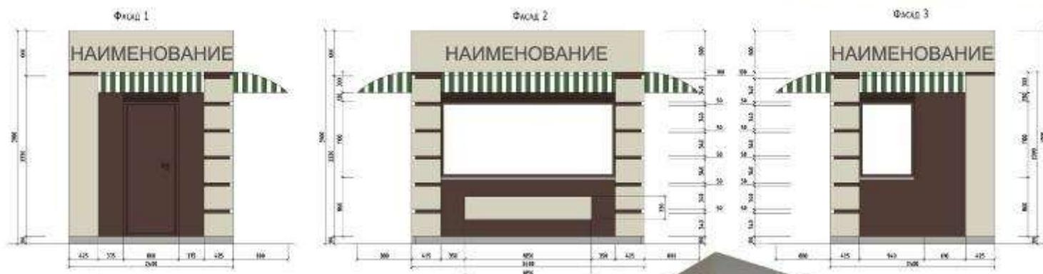
Конструктив: металлический каркас, стеновой наполнитель (сэндвич-панели), стеклопакеты.
