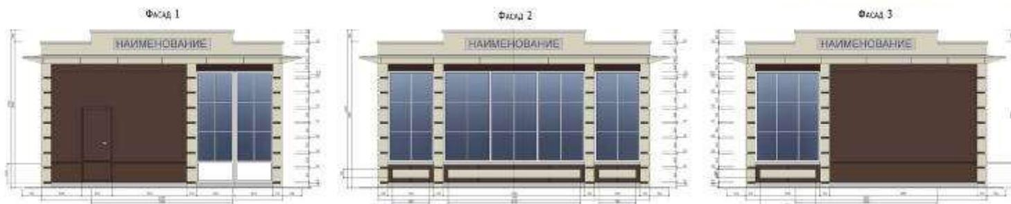
Конструктив: металлический каркас, стеновой наполнитель (сэндвич-панели), стеклопакеты.
